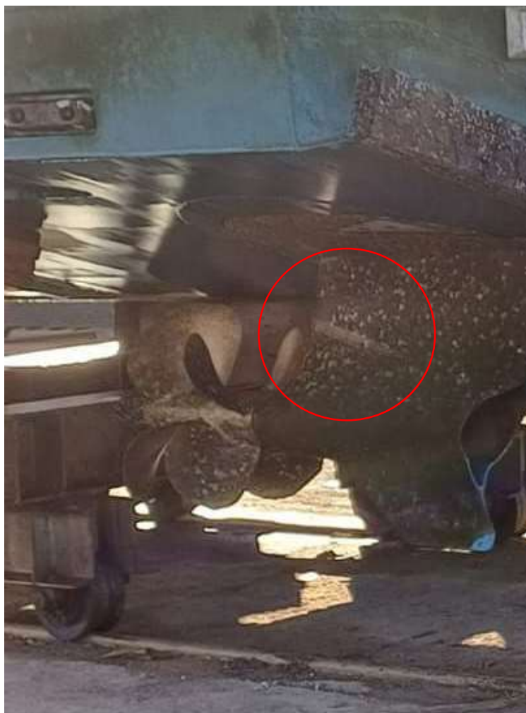
Slika 16. Mehaničko oštećenje premaza
