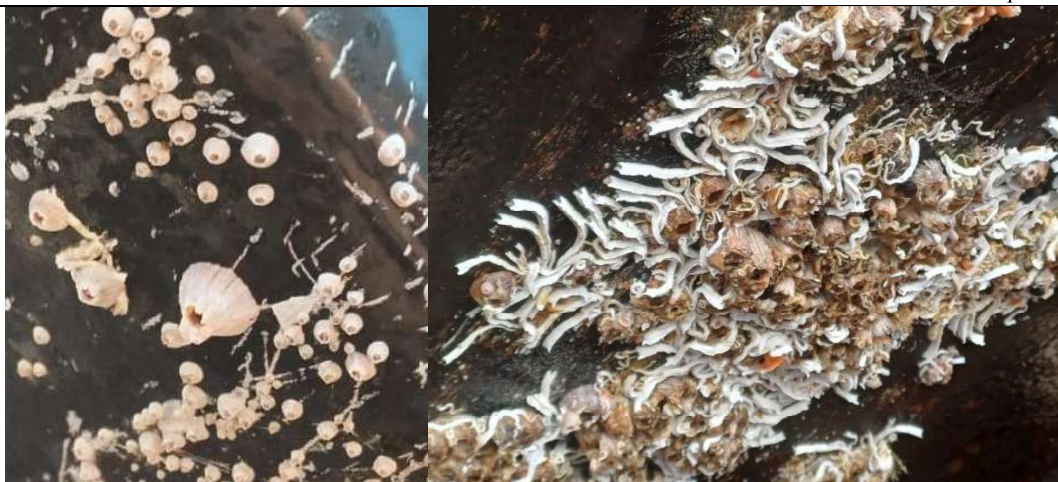
Slika 7. Prikaz ljušture balanida nakon pranja broda (lijevo) i naseljenost površine oštećenog silikonskog premaza (desno)
