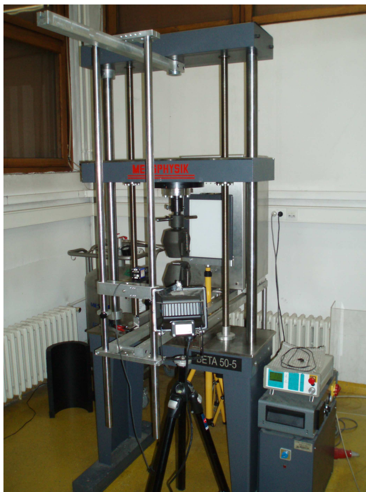
Slika 5.19. Stroj za ispitivanje mehaničkih svojstava Messphysik BETA 50-5
