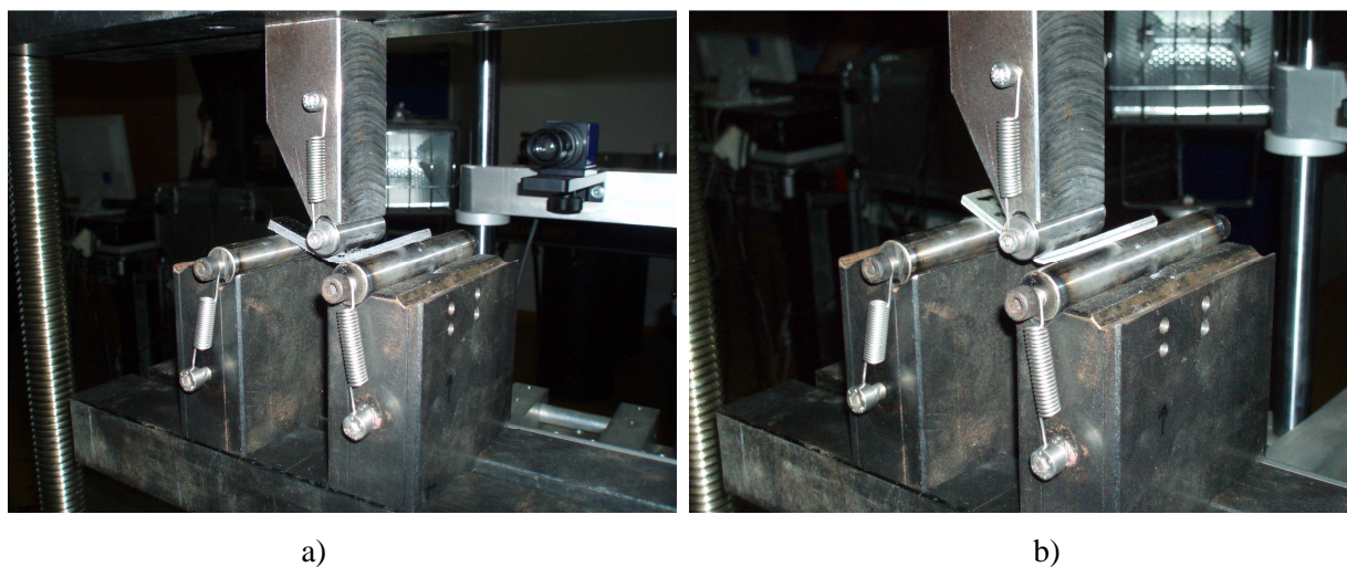
Slika 5.20. Metoda ispitivanja savojnih svojstava preko tri točke: a) CSC ispitno tijelo; b) SCS ispitno tijelo
