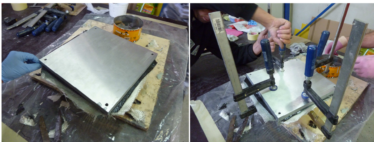
Slika 5.11. Završetak postupka laminiranja kompozitne ploče: a) postavljanje gornje ploče na kalup; b) stezanje gornje i donje kalupne ploče stegama
