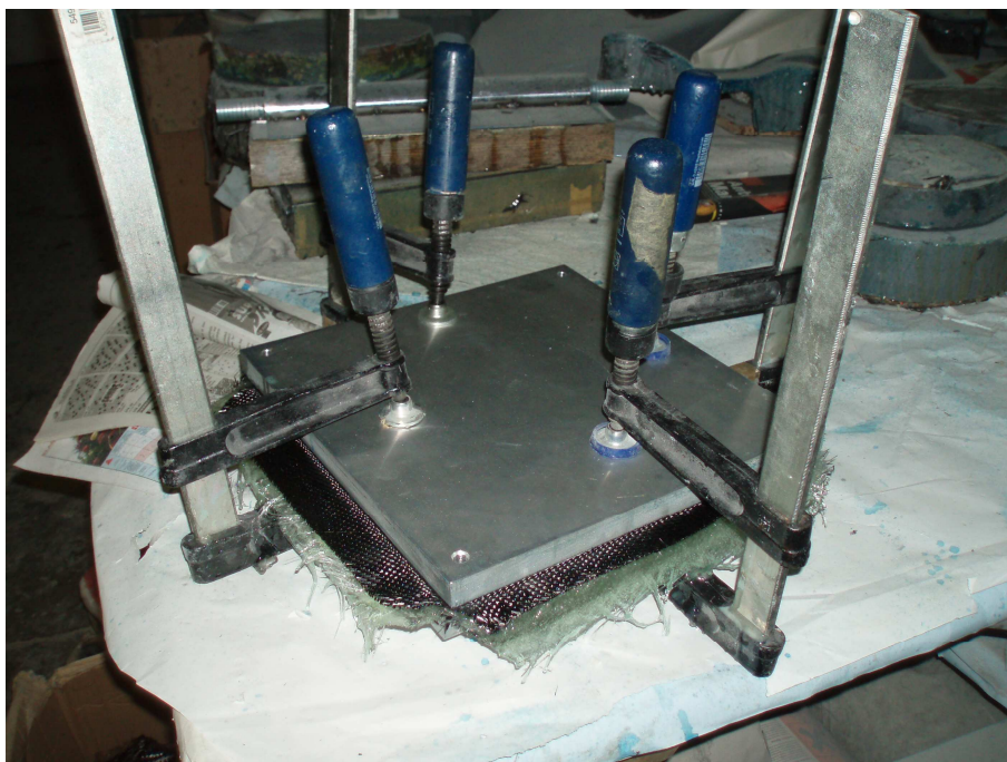
Slika 5.14. Očvrstnuta kompozitna ploča u kalupu nakon njenog vadenja iz peći
