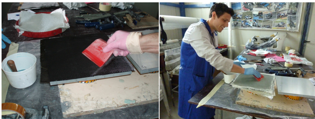
Slika 5.9. Impregniranje slojeva raznošenjem smole po površini
