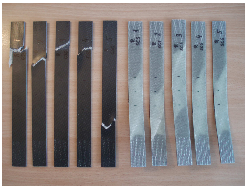
Slika 5.24. Izgled rasteznih ispitnih tijela CSC (ugljik-staklo-ugljik) i SCS (staklo-ugljik-staklo) nakon ispitivanja rasteznih svojstava
