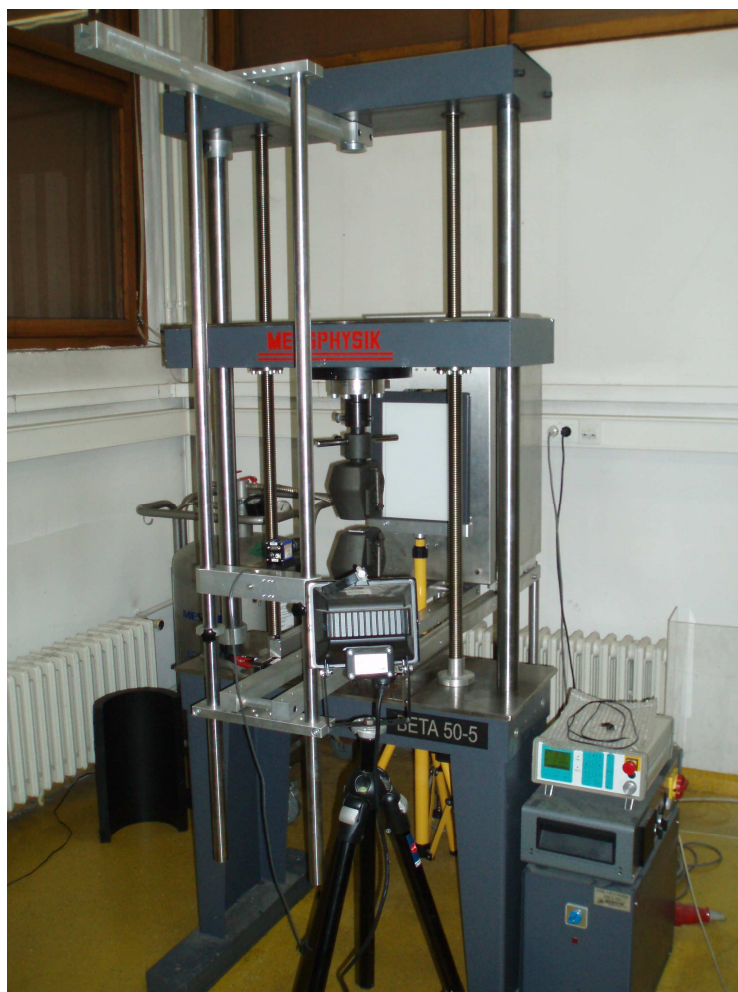
Slika 5.19. Stroj za ispitivanje mehaničkih svojstava Messphysik BETA 50-5
