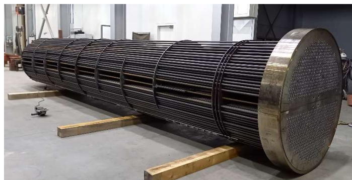
Slika 2. U-cijevni snop izmjenjivača topline (izvor: Pireko d.o.o)
