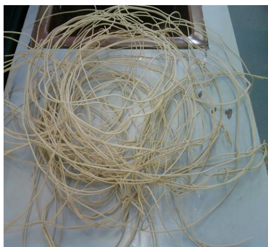
Slika 19. Poluproizvod nakon ekstrudiranja tzv. „špageti“
