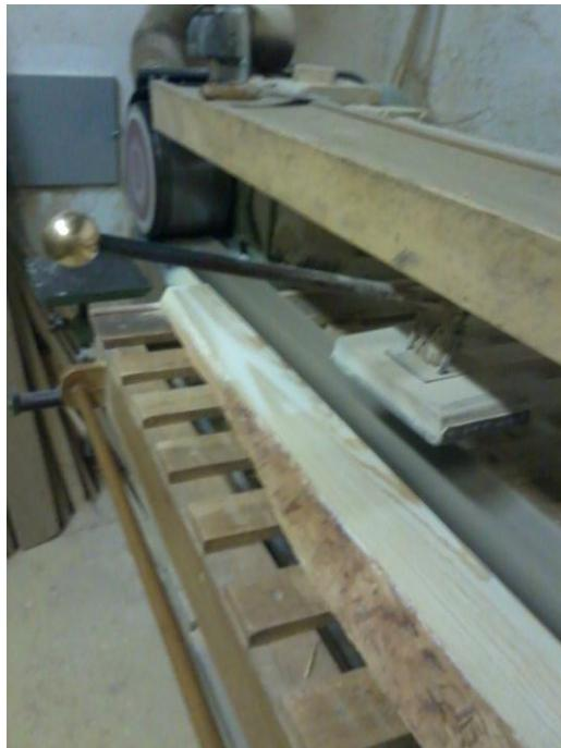
Slika 8. Strojno brušenje daske
