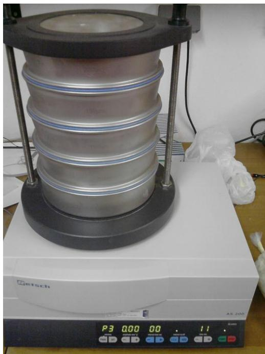
Slika 11. Uređaj za prosijavanje Retsch AS 200
