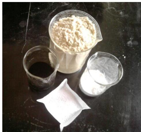
Slika 16. Drvno brašno, Irganox u prahu, CaCO<sub>3</sub>, reciklirana guma
