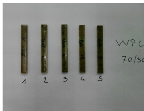
Slika 31. Epruvete ( WPC 70/30) za savojno ispitivanje
