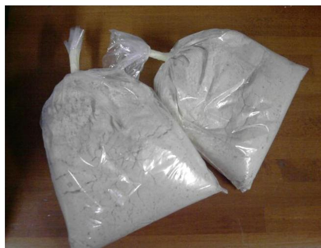
Slika 10. Drvno brašno nakon brušenja
