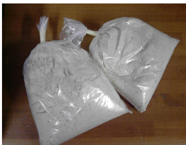
Slika 10. Drvno brašno nakon brušenja
