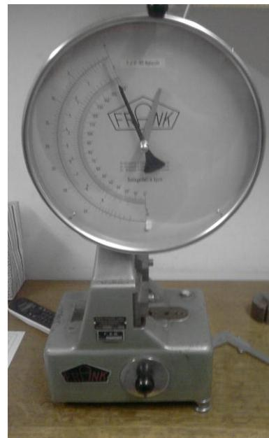
**Slika 34. Uredaj za ispitivanje udarne radnje loma**
