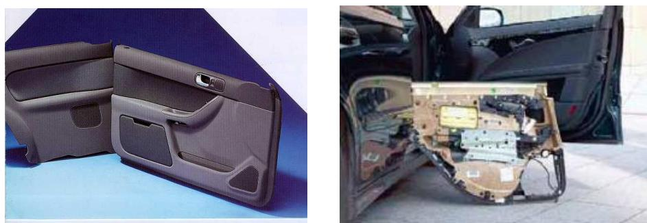
Slika 5. Primjenadrvno polimernog kompozita uautomobilskoj industriji [7]
