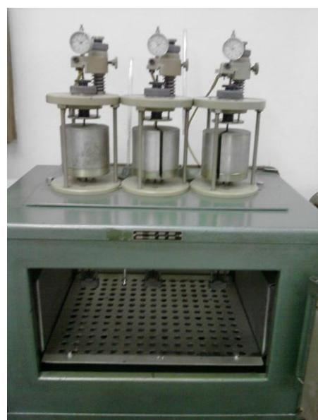
**Slika 38. Uredaj za ispitivanje temperature omekšavanja**
