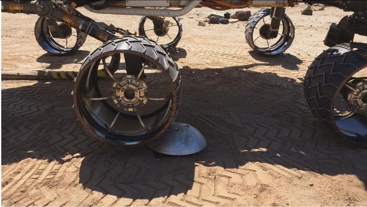
Slika 9. Prelazak kotača preko aluminijske prepreke [8]
