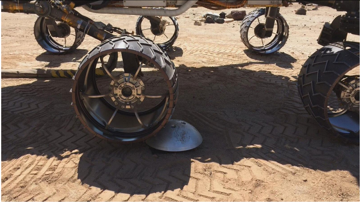
Slika 9. Prelazak kotača preko aluminijske prepreke [8]
