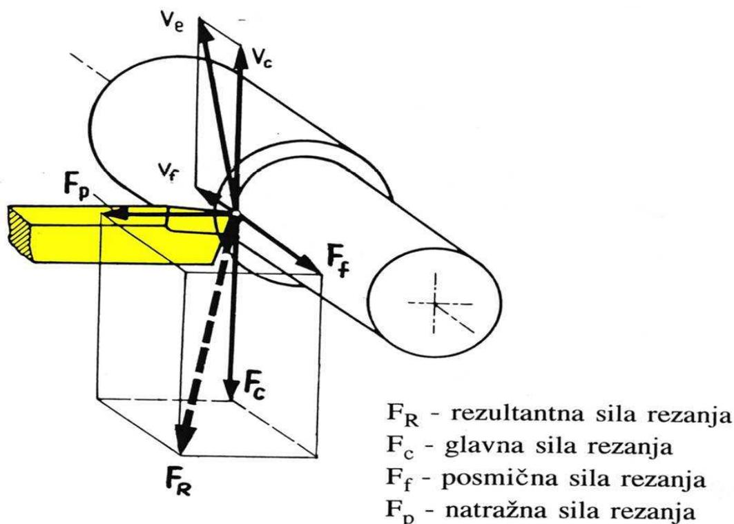
Slika 4. Komponente sile rezanja kod kosog rezanja [4]
