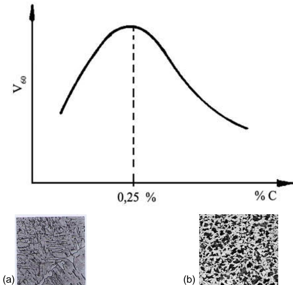
**Slika 10. Ovisnost obradivosti o sadržaju ugljika kod nelegiranih čelika (a) Widmannstättenova struktura (b) Grubozrnata struktura [2] [9]**
