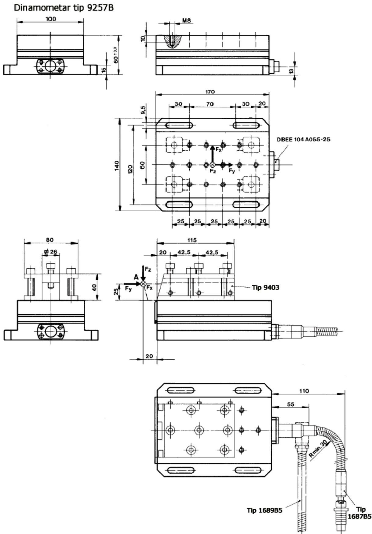
Slika 20. Prikaz uređaja za mjerenje sila [17]
