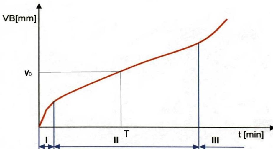
**Slika 3.** Tipična krivulja trošenja reznih alata [6]
