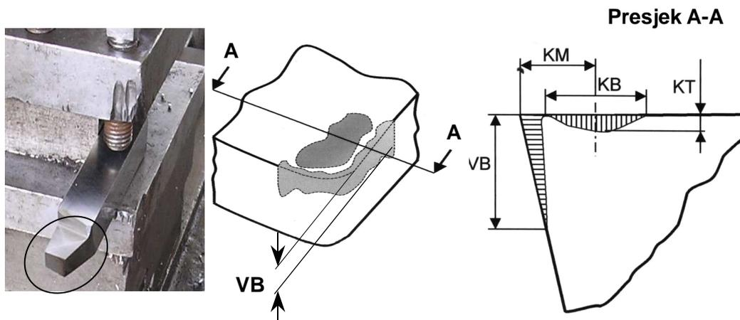
**Slika 2.** Parametri trošenja oštrice reznog alata (VB – istrošenost stražnje površine alata, KM – udaljenost od središta kratera do teorijskog vrha oštrice, KB – širina kratera, KT – dubina kratera) [6]
