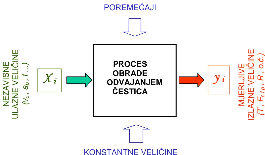
Slika 6. Shematski prikaz procesa obrade odvajanjem čestica [7]
