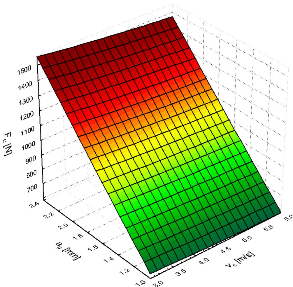
Slika 21. Dijagram ovisnosti  $F_c=f(v_c, a_p)$  za  $f_{sr}=0,18$  mm
