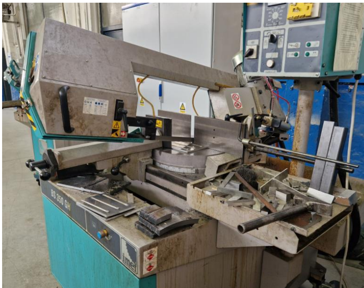
Slika 48. Pila za rezanje uzoraka „BS 350 GH“
