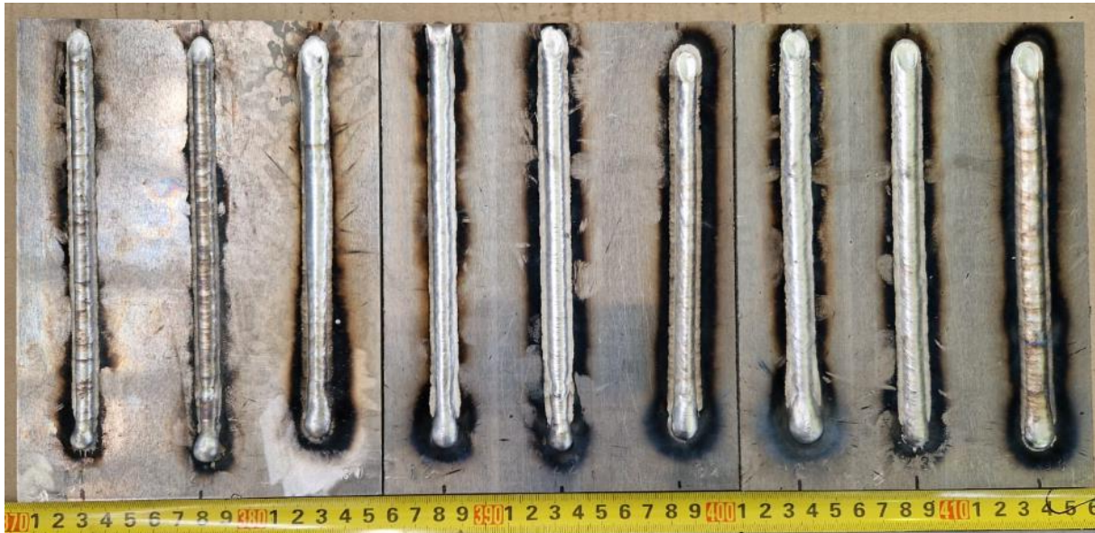
Slika 37. Prikaz svih uzoraka nakon navarivanja
