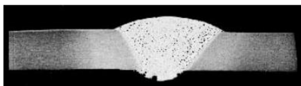
Slika 5. Poroznost u TIG zavaru ploče debljine 6 mm [5]
