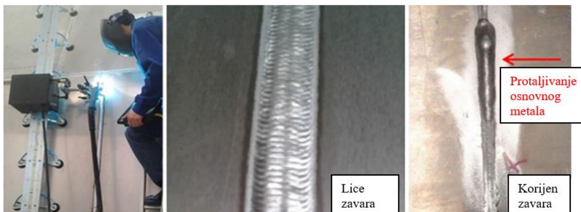
Slika 1. Automatizirani postupak DC impulsnog MIG zavarivanja trupa jedrilice od aluminija i problemi kod zavara [4]
