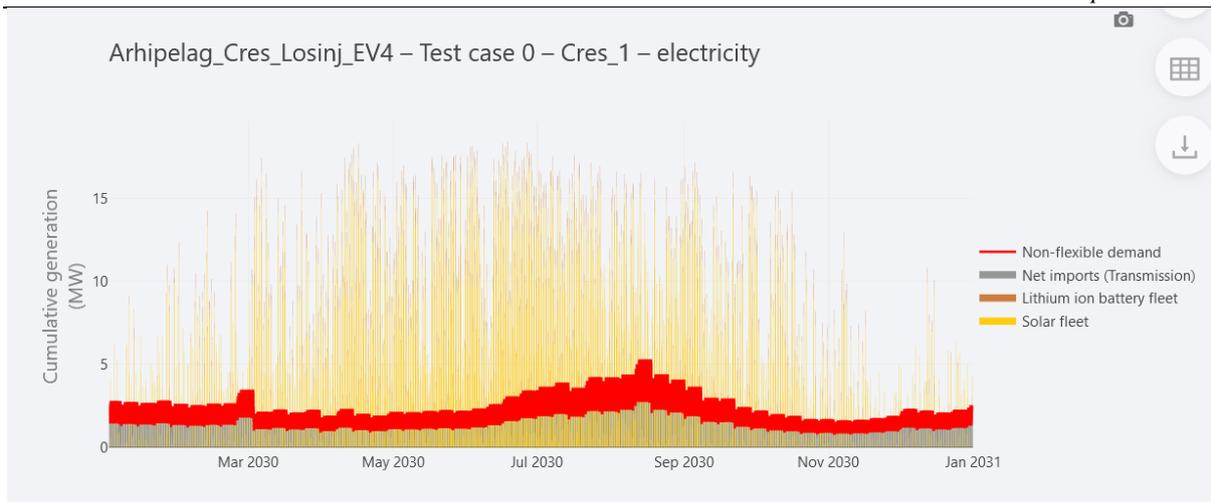
**Slika 25. Satna proizvodnja iz FN, rad baterijskog sustava i uvoz električne energije na Cresu - 2030.**
