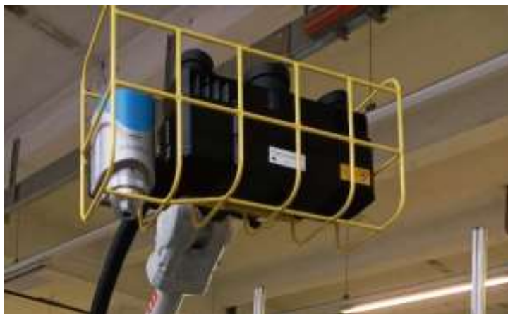
Slika 9. Zaštitna konstrukcija sa senzorima na prihvatnici robota
