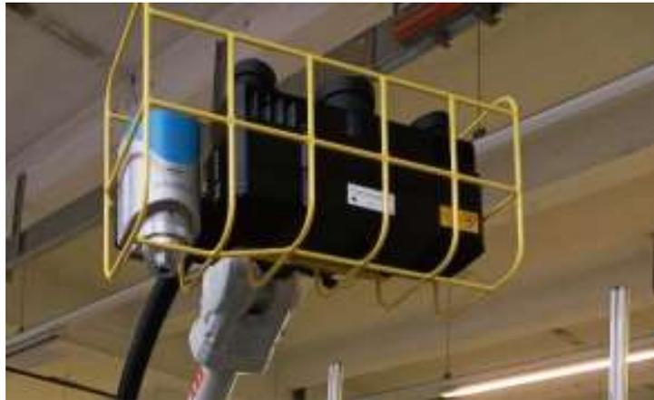
Slika 9. Zaštitna konstrukcija sa senzorima na prihvatnici robota
