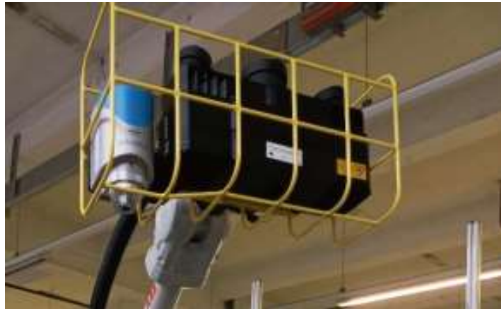
Slika 9. Zaštitna konstrukcija sa sensorima na prihvatnici robota
