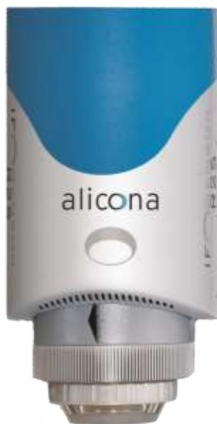
Slika 15. Mjerni uređaj Alicona IF-SensorR25 [4]
