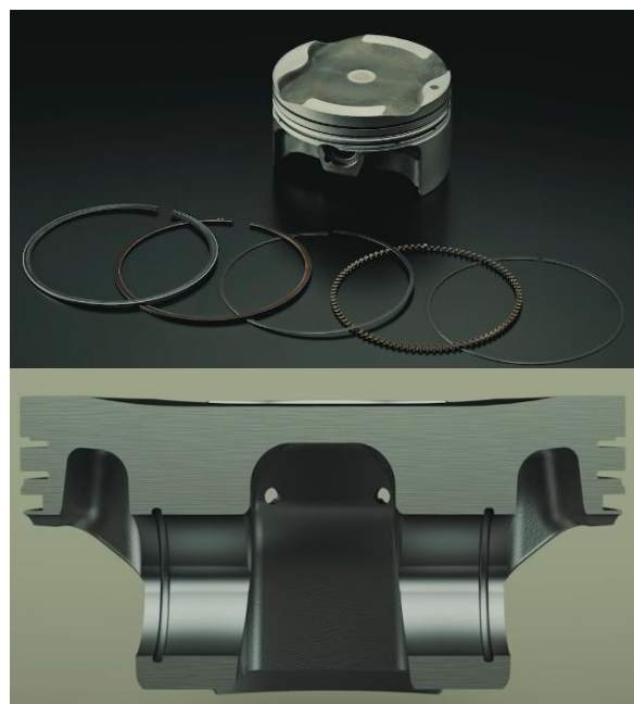
Slika 18: Hayabusa - klip i klipni prstenovi [11]
