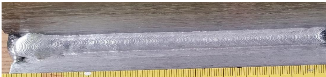
Slika 45. Naličje kutnog zavora A2 izvedenog u zaštiti 100% argona uz f=20 Hz
