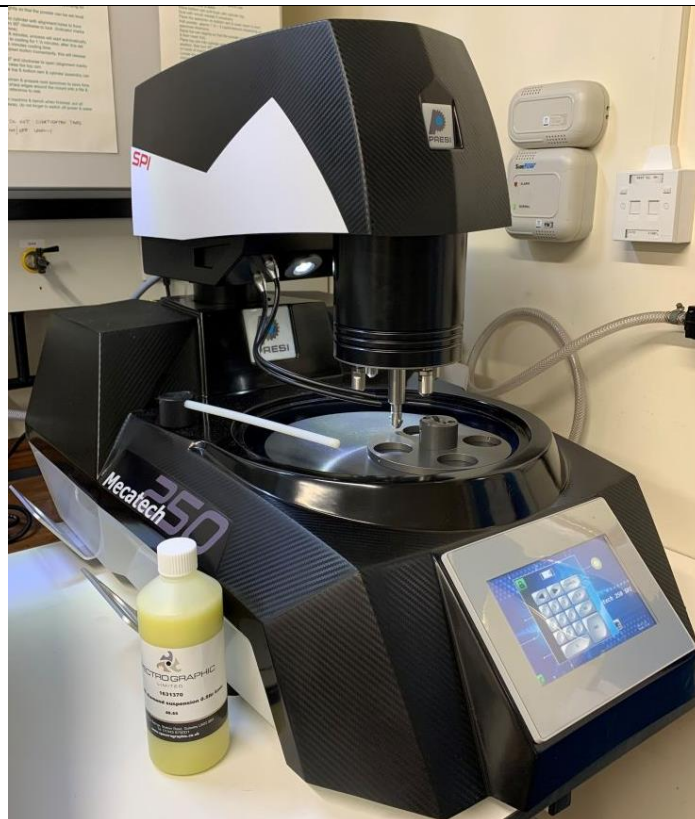
Slika 50. Uređaj za poliranje uzoraka Presi Mecatech 250 SPI
