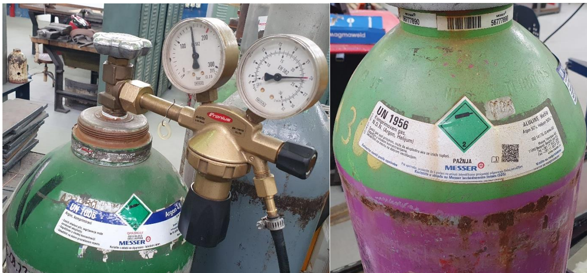
Slika 40. Korišteni zaštitni plinovi za zavarivanje Argon 4,8 lijevo i Aluline He50 desno
