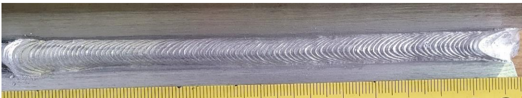
Slika 44. Naličje kutnog zavora B1 izvedenog u zaštiti argona s 50% helija uz f=8 Hz
