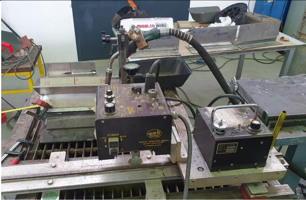
Slika 39. Automat za zavarivanje BUG 5300 Speed Weaver II
