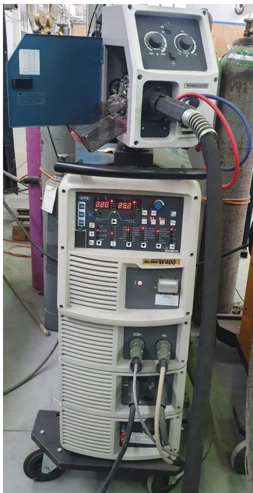
Slika 38. Izvor struje za zavarivanje Daihen Varstroj Welbee W400
