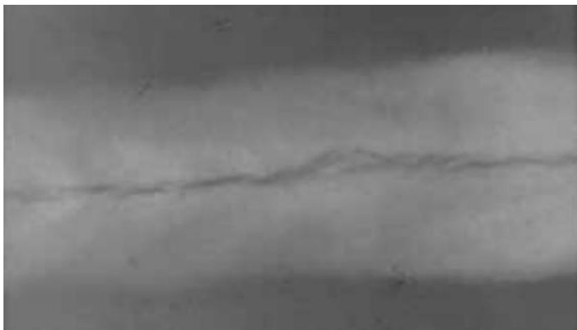
Slika 32. Radiografska snimka uzdužne pukotine zavara aluminija [8]
