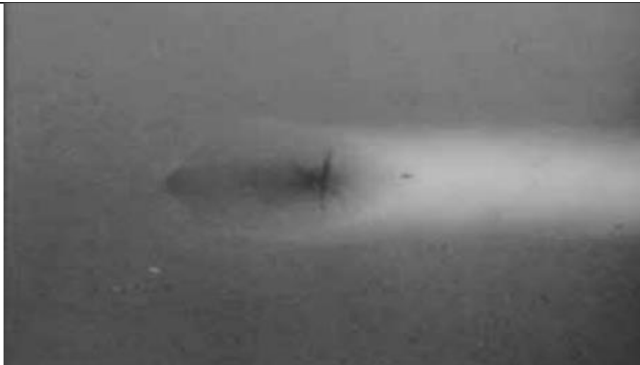
Slika 31. Radiografska snimka kraterske pukotine [8]
