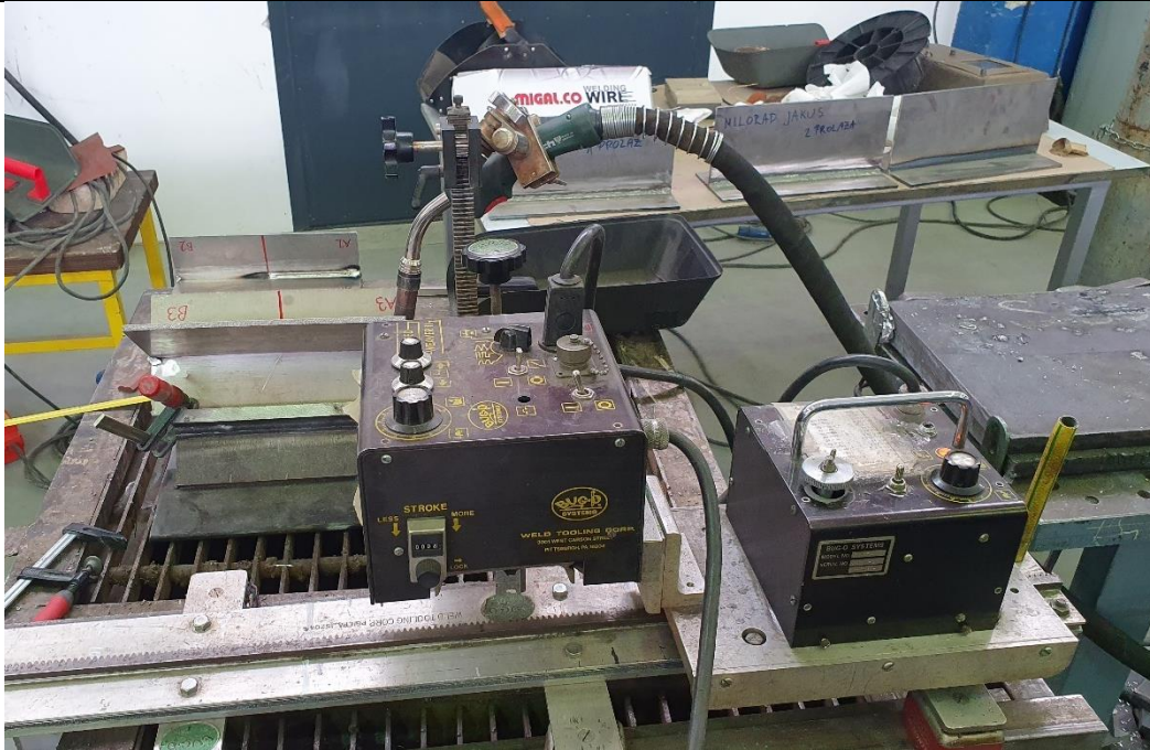
Slika 39. Automat za zavarivanje BUG 5300 Speed Weaver II
