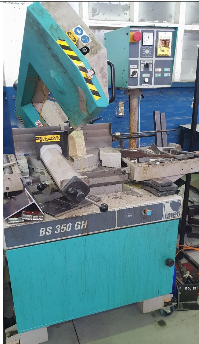
Slika 49. Tračna pila imet BS 350 GH
