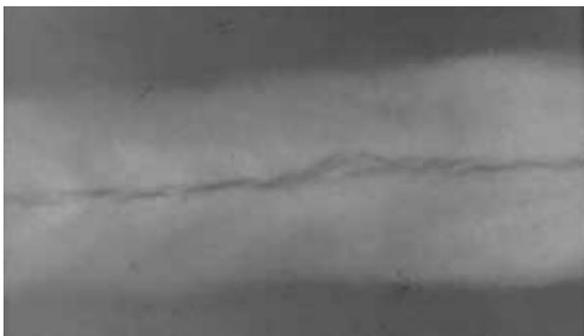
Slika 32. Radiografska snimka uzdužne pukotine zavara aluminija [8]
