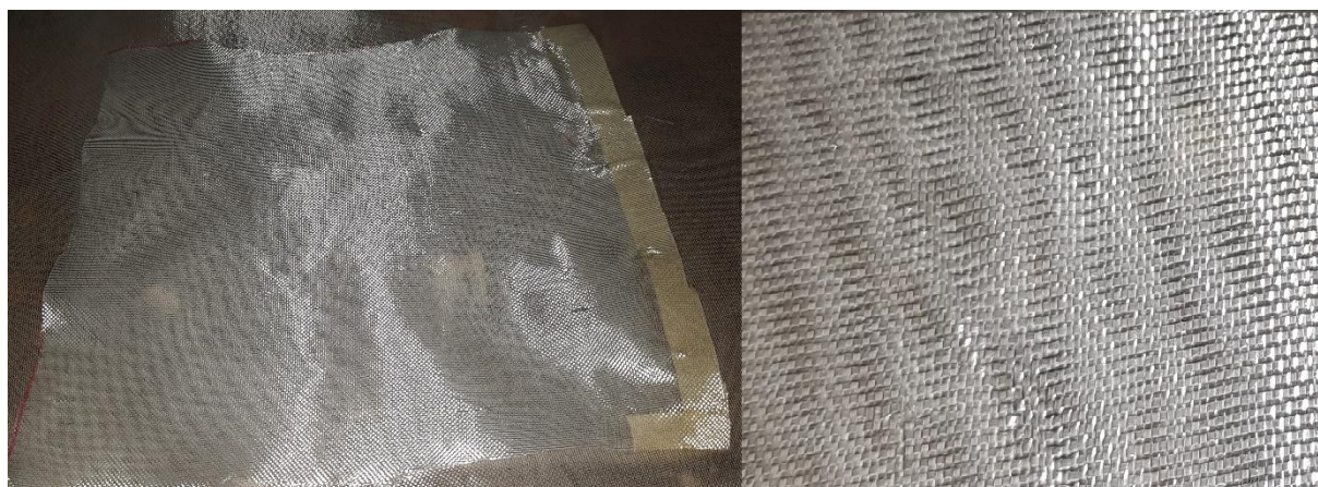
Slika 7. Tkanje staklenih vlakana (e. woven)
