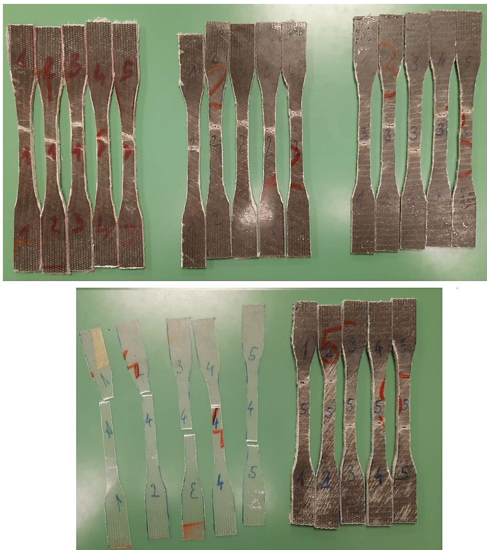
Slika 14. Ispitna tijela nakon provedenog rasteznog ispitivanja
