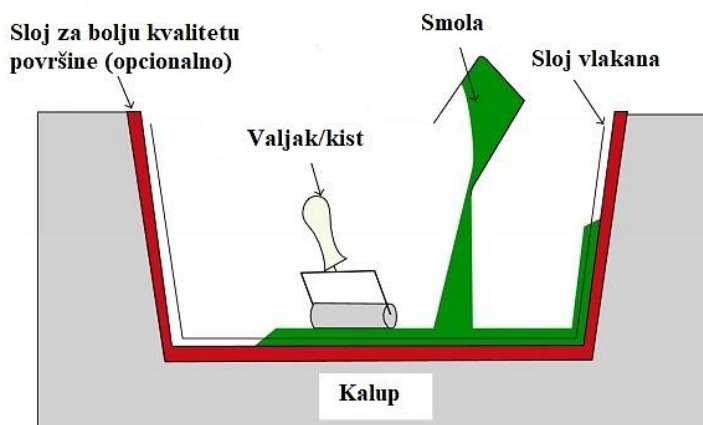
Slika 6. Shematski prikaz postupka ručnog polaganja [34]
