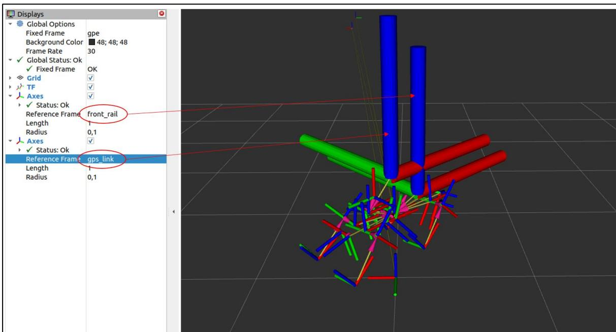
**Slika 23. Statičke transformacije koordinatnog sustava GNSS prijamnika u odnosu na bazu sustava za dodatke**
