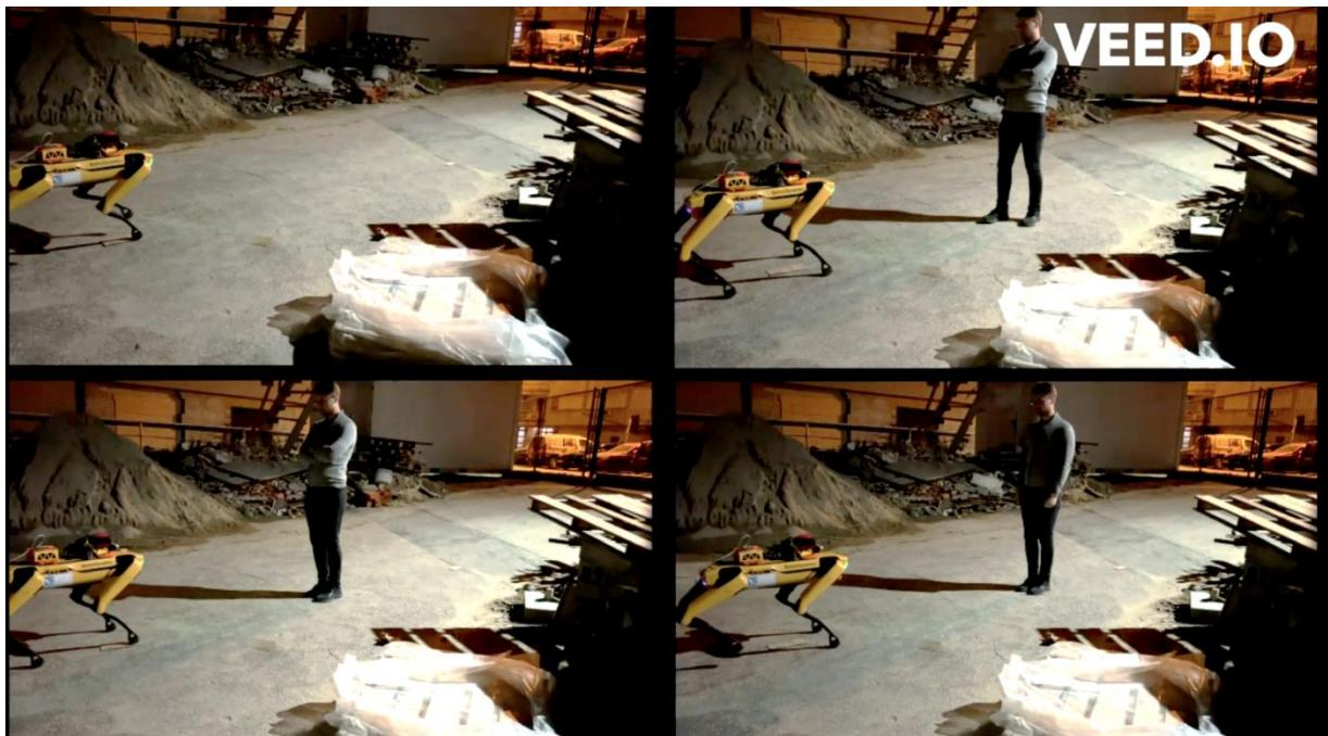
**Slika 47. Kompilacija praćenja putnih točaka Spot mobilnog robota s postavljenim preprekama prikazana u videu [87]**
