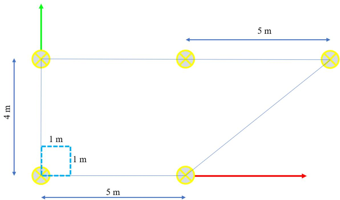
**Slika 43. Prikaz putnih točaka korištenih za validaciju navigacije Spot mobilnim robotom**
