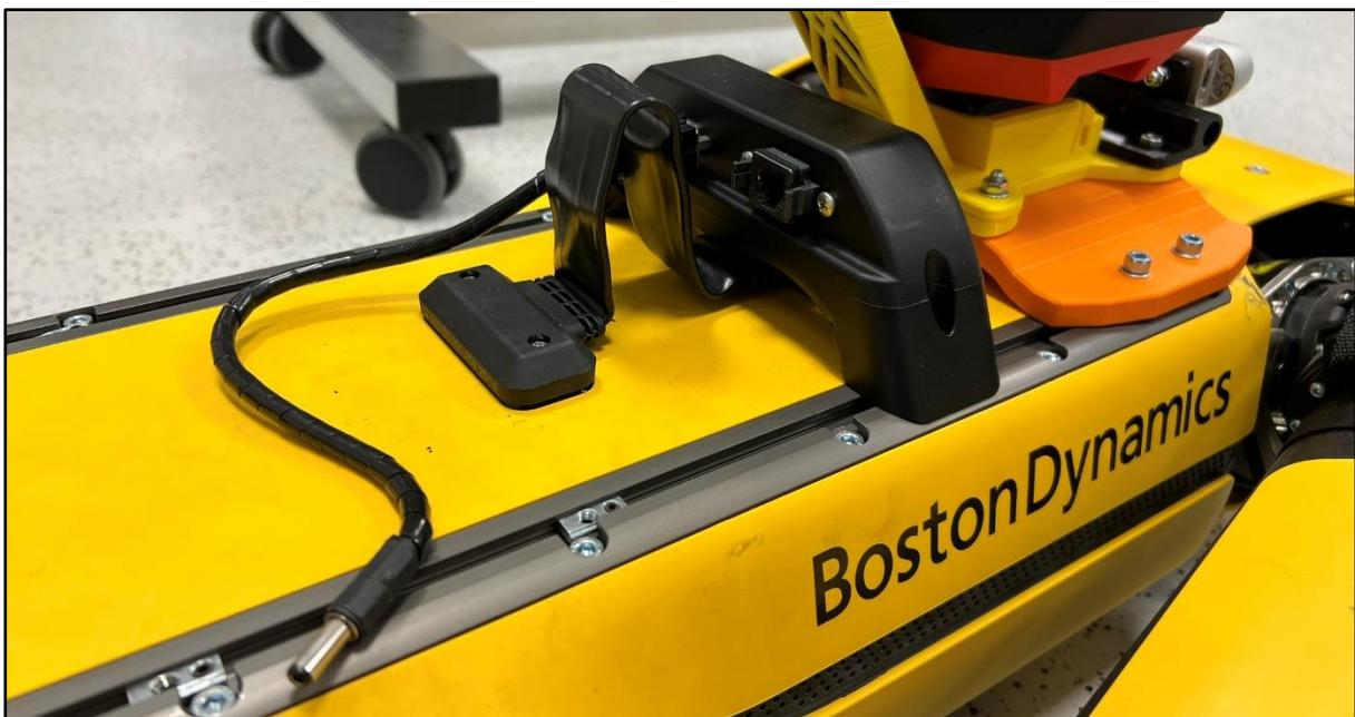
Slika 30. Spot dodatak za proširenje montirani na robotu
