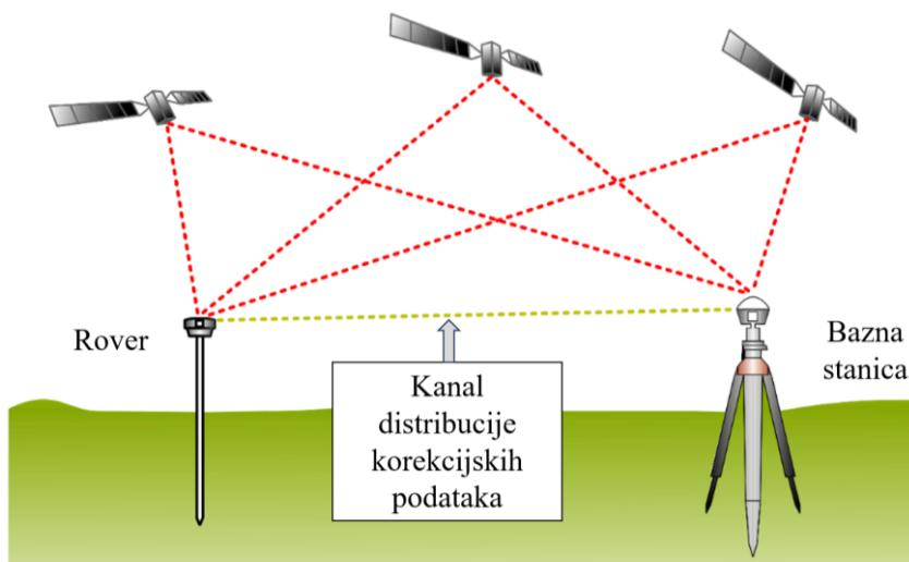
**Slika 3. Prikaz GNSS RTK sustava baze i rovera [14]**
