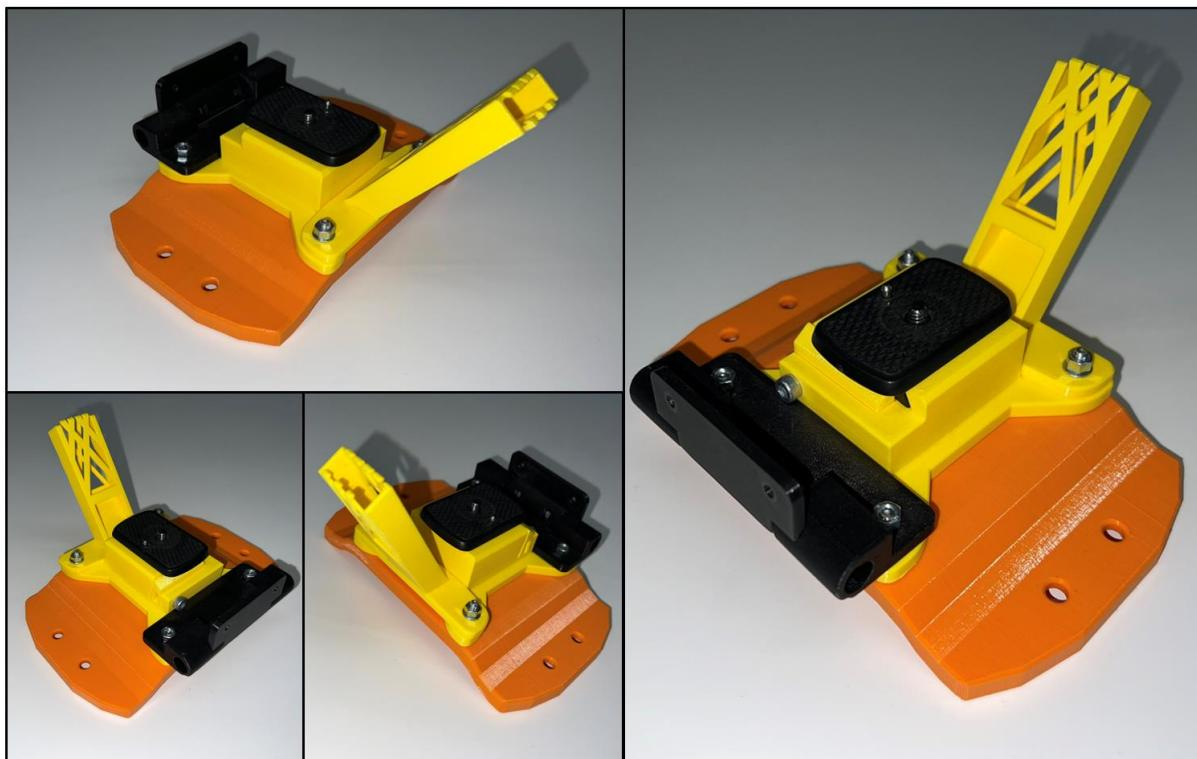
**Slika 28. Nosač Intel RealSense D435i kamere postavljen na nosač GNSS prijamnika**
