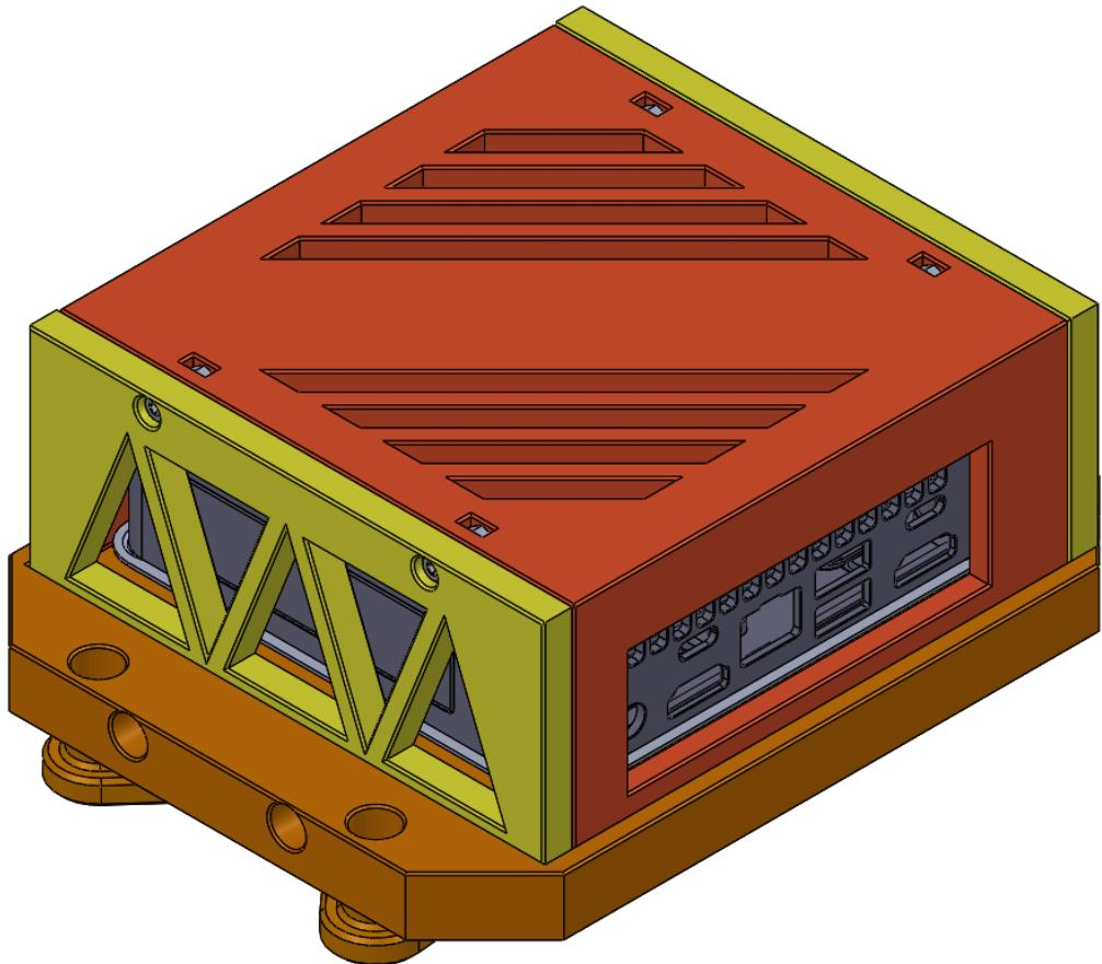
**Slika 25. Model sklopa kućišta Intel NUC računala**
