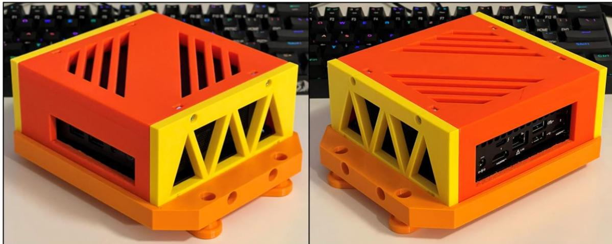
**Slika 27. Intel NUC računalo postavljen na nosač**
