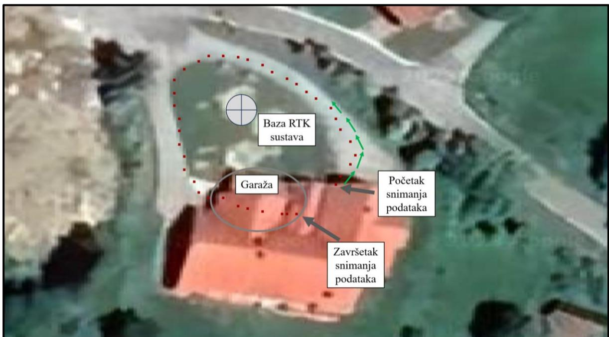
Slika 12. Rezultat testiranja RTK opreme – detaljniji prikaz
