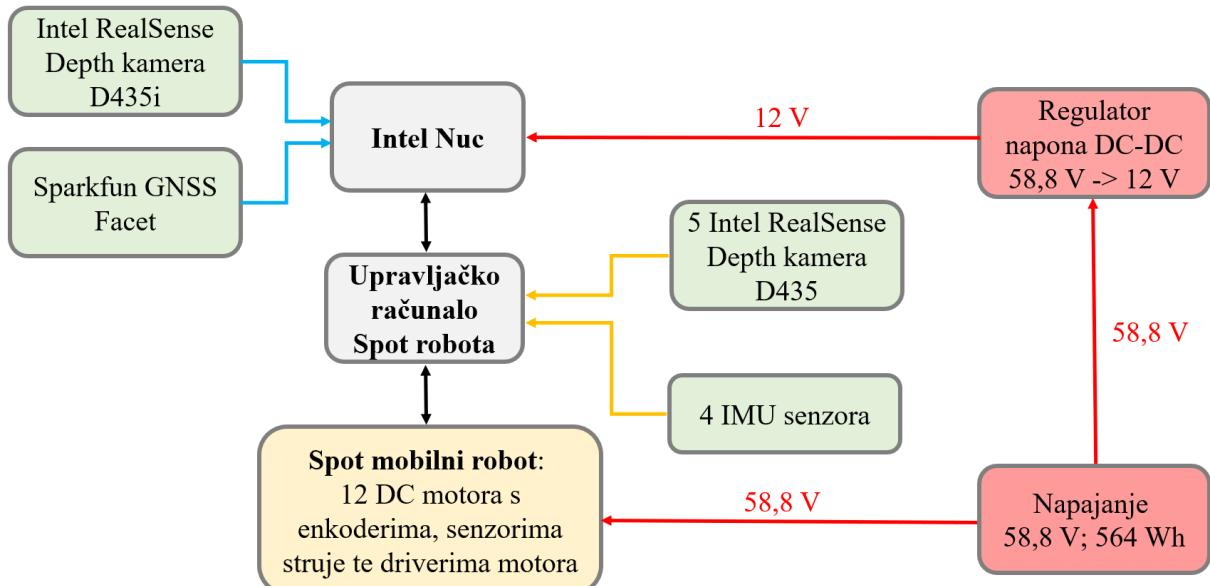
**Slika 20. shematski prikaz spajanja komponenti korištenih u zadacima globalne navigacije mobilnog robota**
