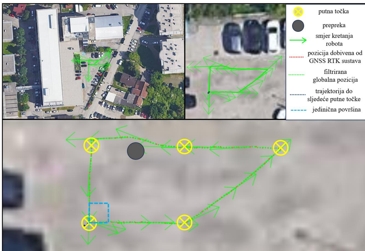
Slika 45. Praćenje putnih točaka Spot mobilnog robota s jednom postavljenom preprekom prikazano u videu [85]
