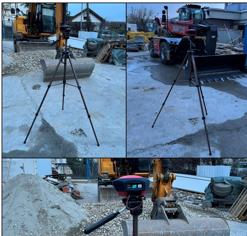
Slika 5. SparkFun RTK Facet u ulozi bazne stanice postavljena
