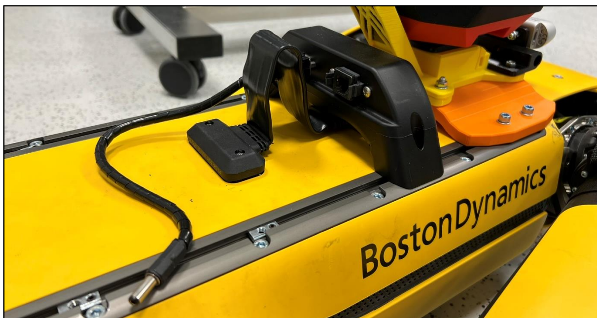
Slika 30. Spot dodatak za proširenje montirani na robotu
