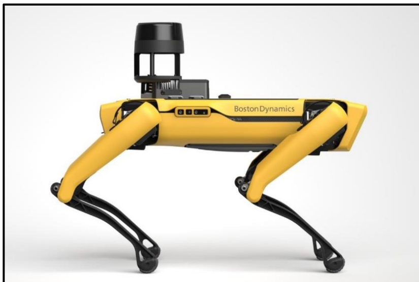
Slika 17. Spot s dodatkom poboljšane autonomije (EAP) [32]
