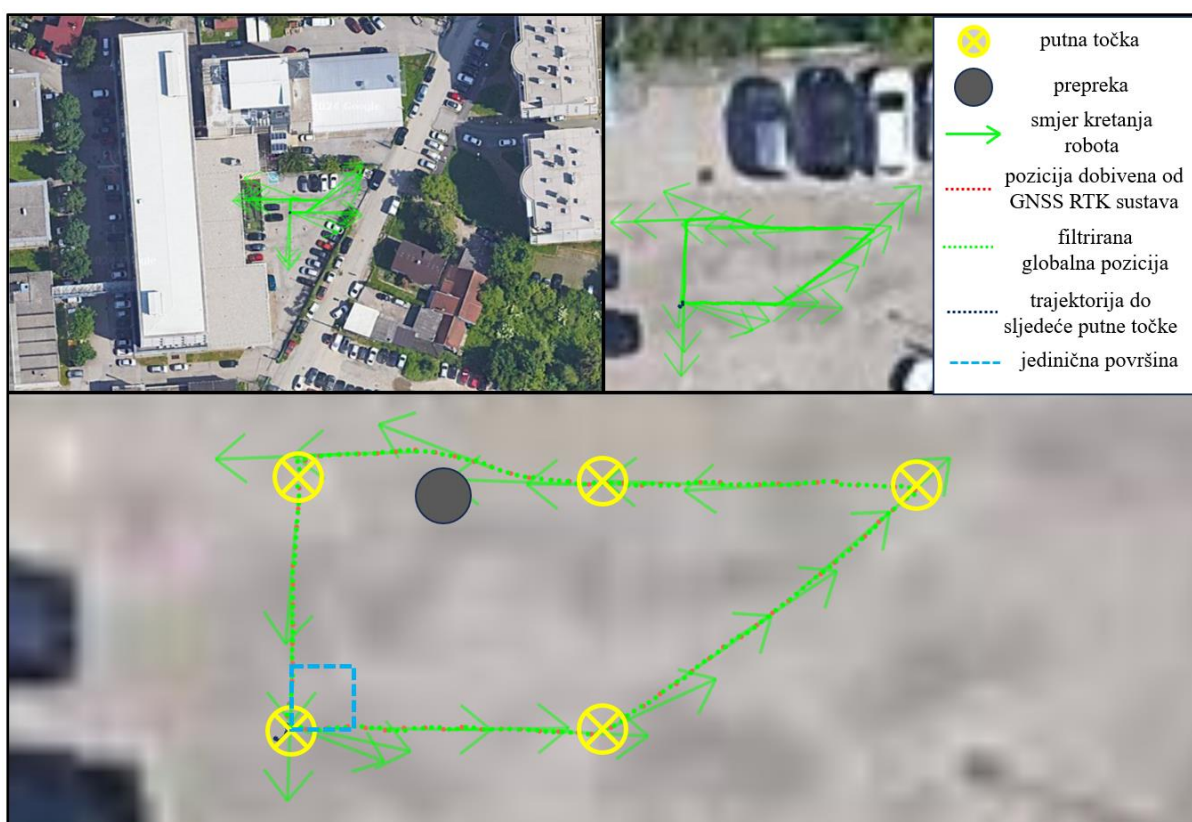
Slika 45. Praćenje putnih točaka Spot mobilnog robota s jednom postavljenom preprekom prikazano u videu [85]
