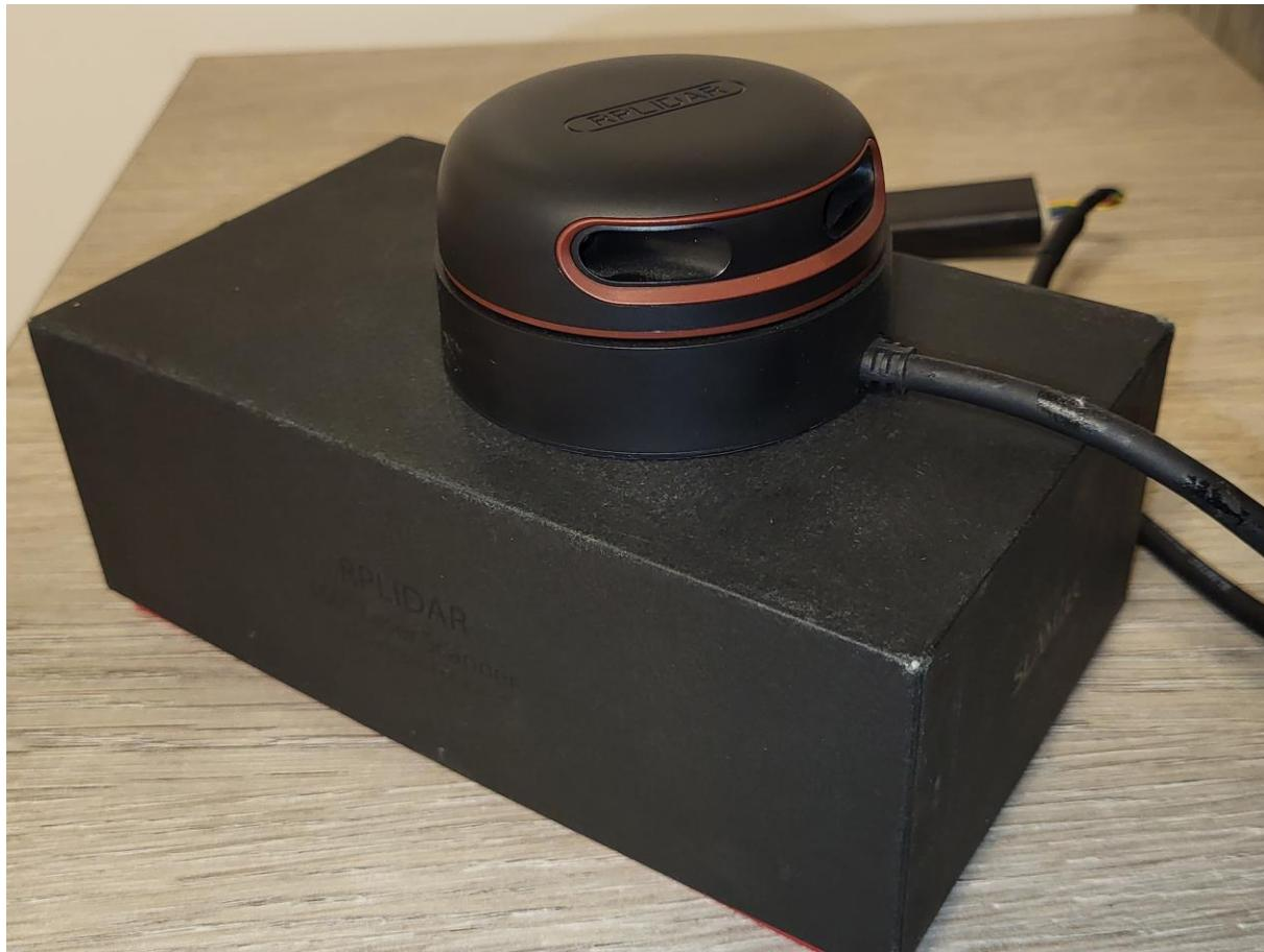
Slika 1. Slamtec-ov RPLIDAR A2
