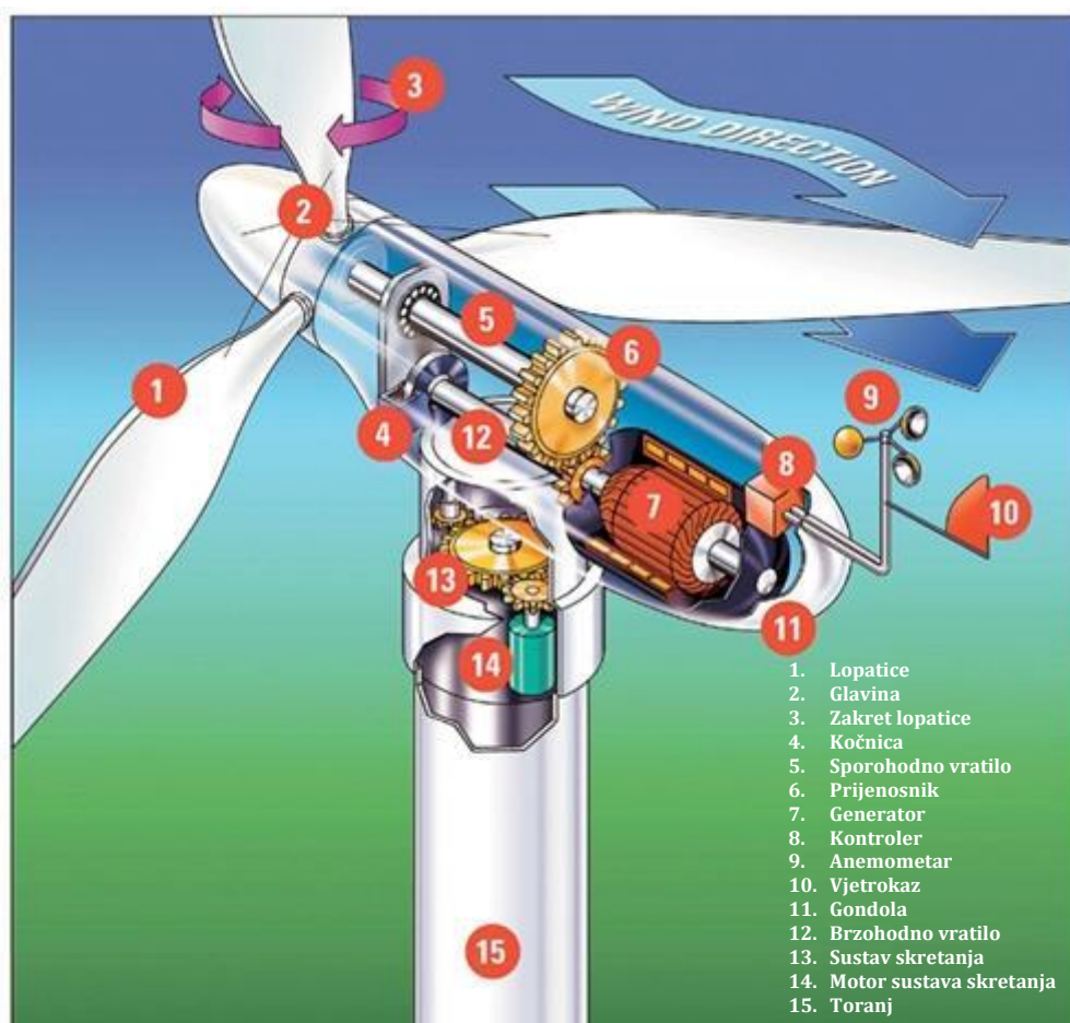
Slika 3.1 Shematski prikaz dijelova vjetroturbina
