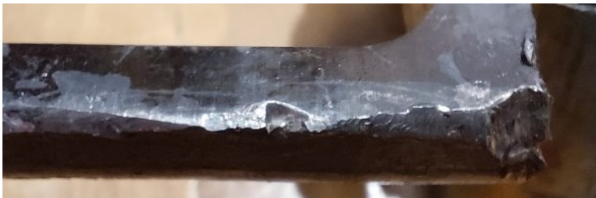
Slika 30. Detalj otkrhnute oštrice s Eggsecutionera_V3
