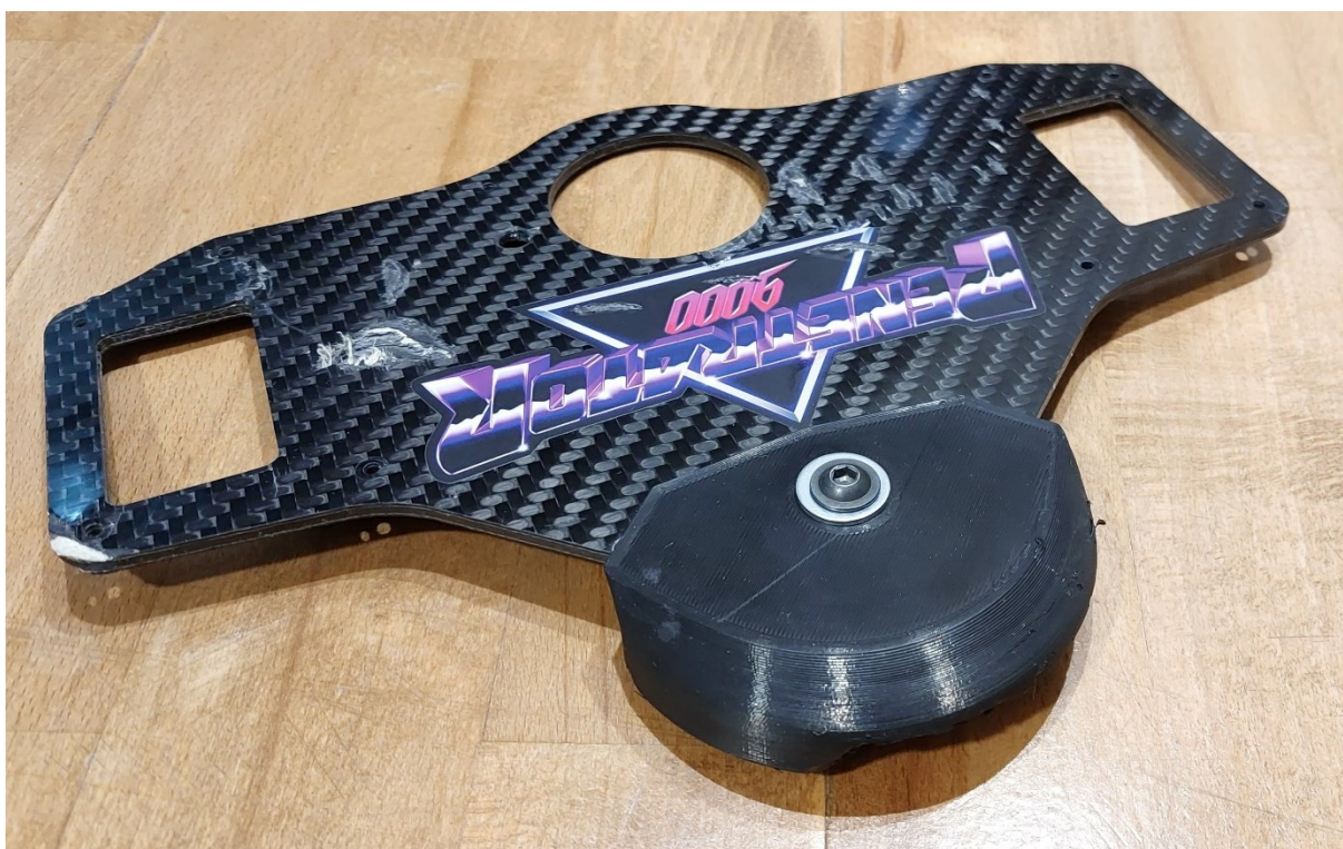
Slika 16. TPU oklop robota horizontalca koji štiti ploču od karbon-kevlara
