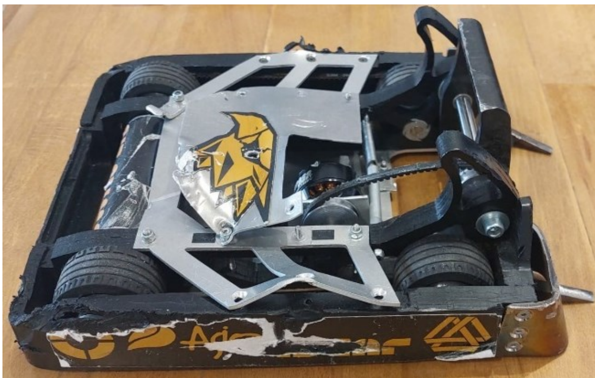
Slika 59. Šteta na Eggsecutioneru_V3
