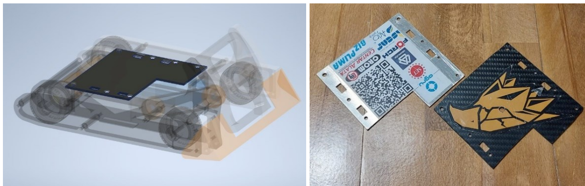
Slika 44. CAD gornjeg poklopca Penzionera (lijevo) i zapravo (desno)
