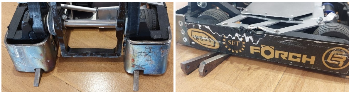
Slika 53. Klinovi na robotu (lijevo) i simulacija podkopavanja (desno)
