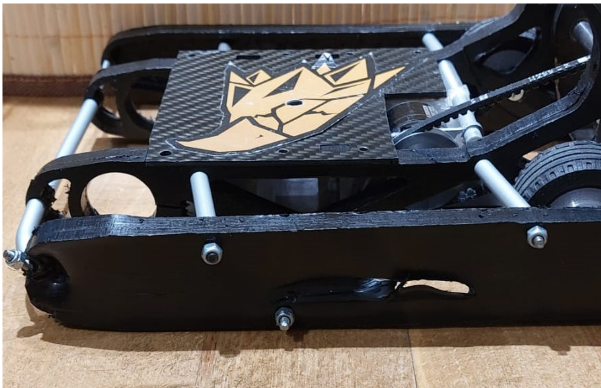
Slika 56. Oštećenja na potrošnom oklopu Penzionera nakon borbe s horizontalcom
