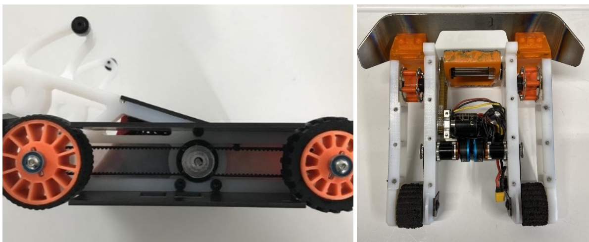
Slika 33. Konfiguracija pogona s motorom u sredini kod robota Lynx [44]
