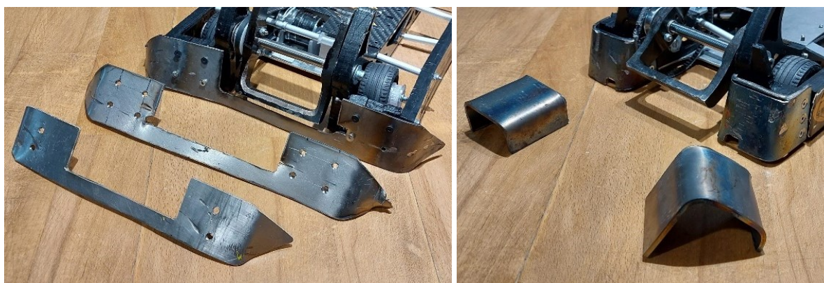
Slika 14. Različite verzije ralica (lijevo) i pokušaji savijanja branika (desno)
