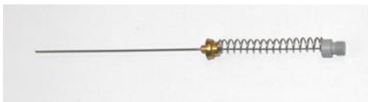
Slika 3.19 Vlakno s ovojnicama DVB/CAR/PDMS (sivo vlakno)
