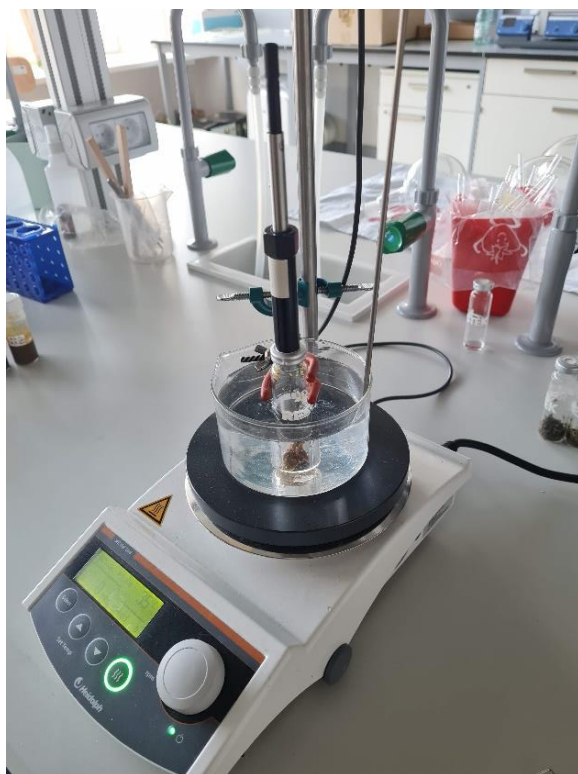
Slika 3.18 Aparatura za mikroekstrakciju vršnih para na krutoj fazi (HS-SPME)
