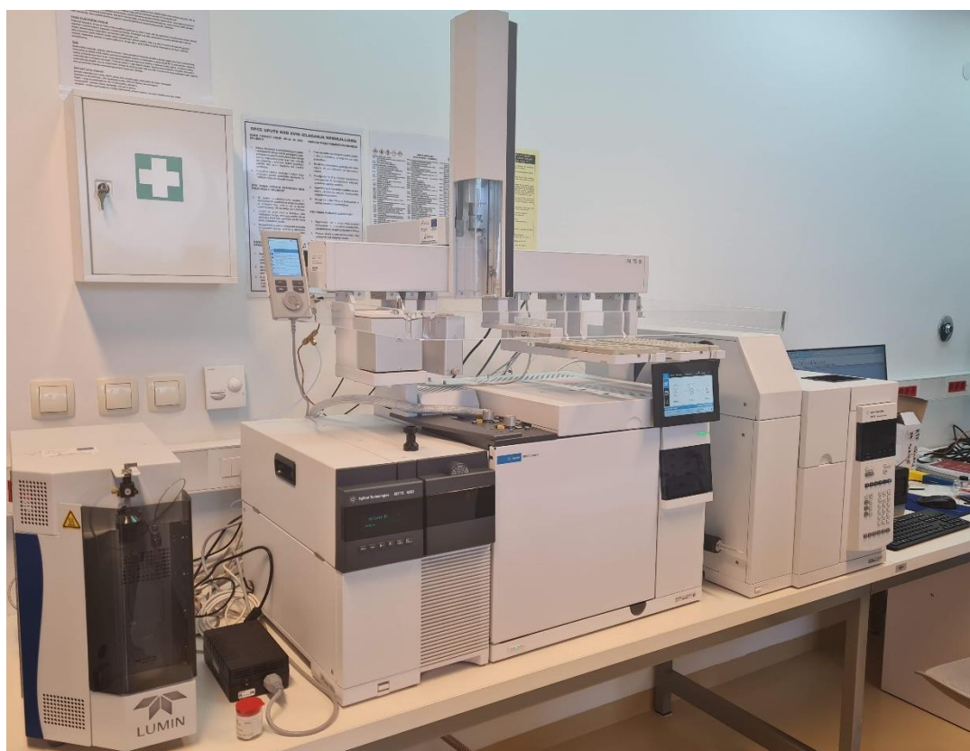
Slika 3.20 Vezani sustav plinska kromatografija-spektrometrija masa (GC-MS)
