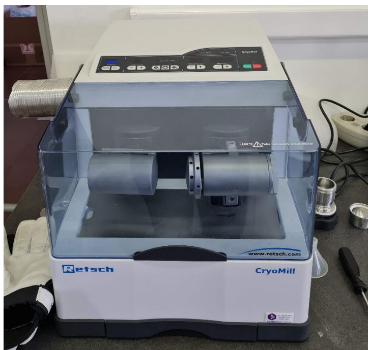
Slika 3.9 Retsch Cryomill uređaj za kriomljevenje uzoraka
