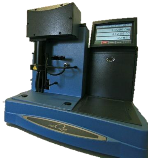
Slika 3.16 Termogravimetrijski analizator Q500
