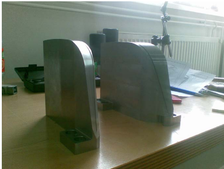
Slika 12.3. Izradak dobiven obradom na 5-osnom CNC stroju
