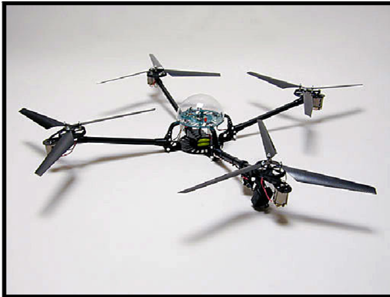
1.1 DraganFlyer X-Pro – daljinski upravljani četverorotorni helikopter
