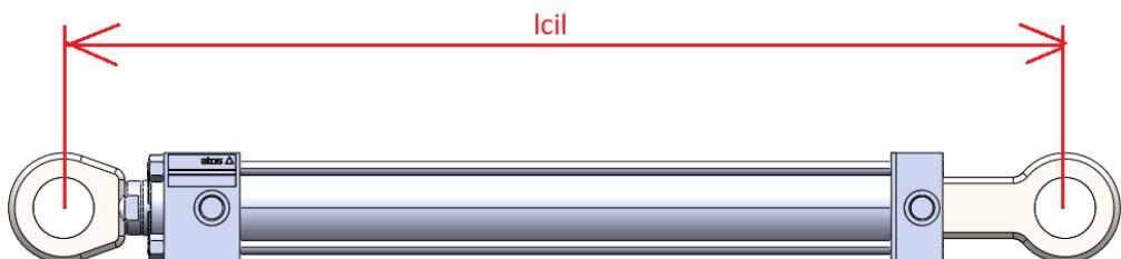
**Slika 13. Duljina cilindra u sklopljenom položaju**
