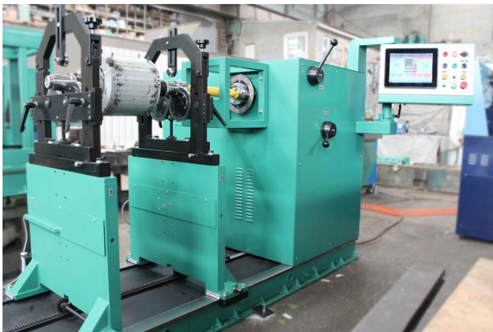
Slika 4 - Izvedba uređaja za balansiranje s krutim osloncima tvrtke VTM Group SERIES 9D [4]
