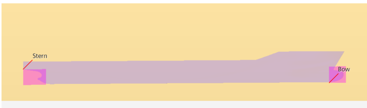
Slika 28. Prikaz volumetrijskih kontrola na krmi i pramcu nakon postavljanja modela broda na određeni kut trima
