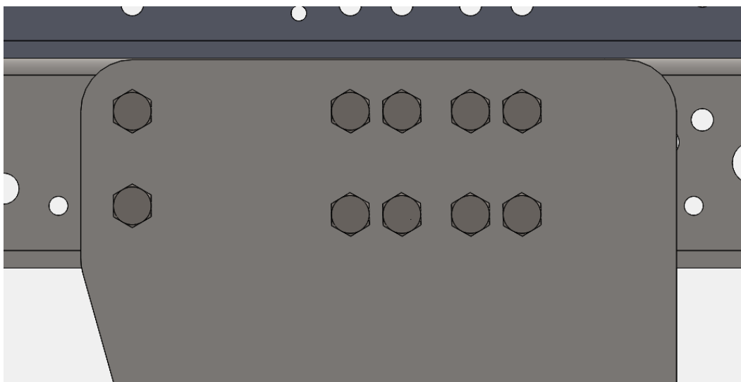
Slika 41. Vijčani spoj s karoserijom
