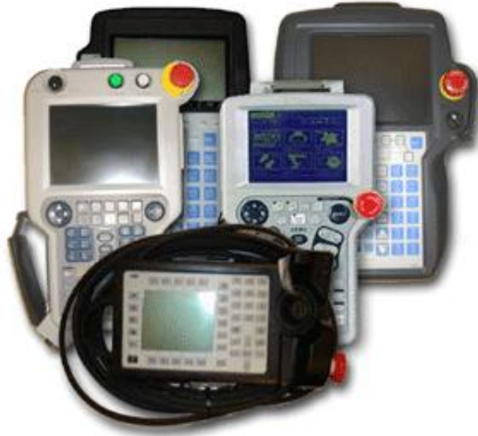
Slika 3.10 Upravljačke ploče različitih industrijskih robota [7]
