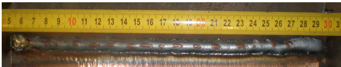
Slika 4.50 Cjeloviti prikaz trećeg prolaza uzorka 3 sučeljenog spoja
