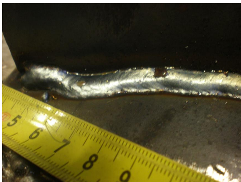
Slika 4.58 Početno odstupanje zbog utjecaja zazora kod uzorka 2
