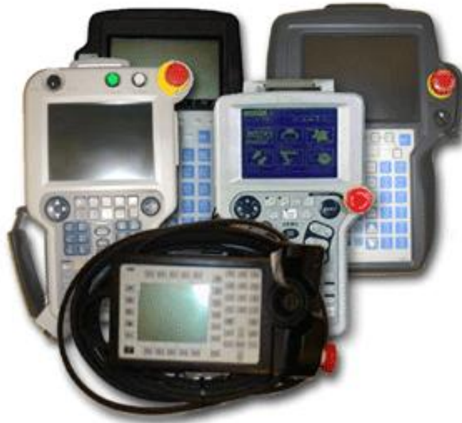
Slika 3.10 Upravljačke ploče različitih industrijskih robota [7]
