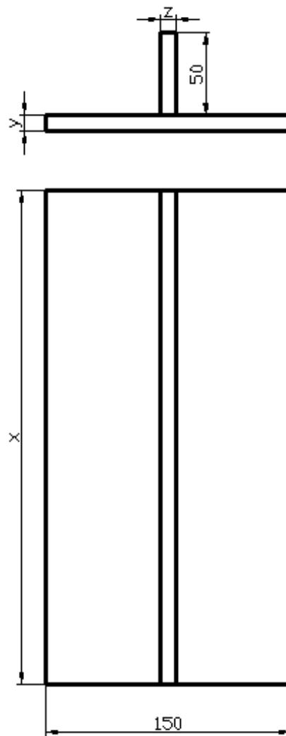
**Slika 4.17** Dimenzije uzorka kutnog spoja prije deformiranja:  $x_1=350\text{mm}$ ,  $y_1=15\text{mm}$ ,  $z_1=12\text{mm}$  (uzorak 1);  $x_2=300\text{mm}$ ,  $y_2=15\text{mm}$ ,  $z_2=12\text{mm}$  (uzorak 2);  $x_3=250\text{mm}$ ,  $y_3=10\text{mm}$ ,  $z_3=10\text{mm}$  (uzorak 3)
