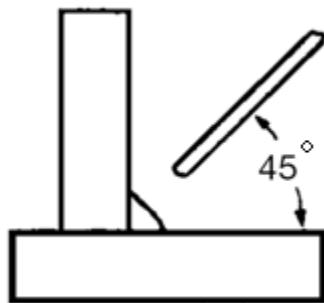
**Slika 4.19** Nagib pištolja koji je potreban namjestiti kod zavarivanja kutnog spoja
