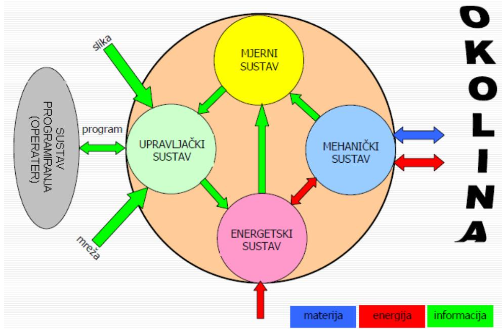
*Slika 3.7 Shematski prikaz funkcionalne strukture robota [5]*
