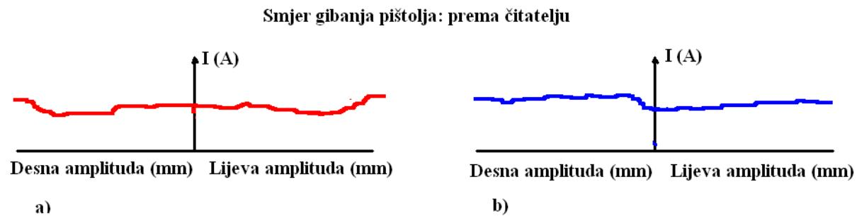
*Slika 4.46 Prepostavljeni signali jakosti struje: a) početna točka; b) točka na desnom rubu (uzorak 2 sučeljenog spoja)*
