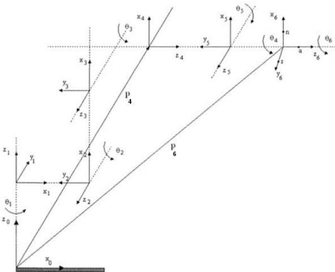
*Slika 3.4 Kinematski odnos koordinatnih sustava robota sa slikama 3.2 i 3.3 [2]*
