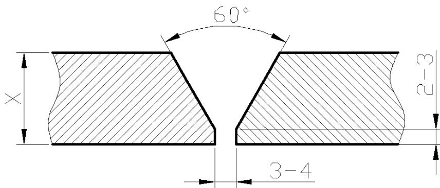
**Slika 4.9** Priprema spoja uzorka sučeljenog spoja:  $x_1=15\text{mm}$  (uzorak 1),  $x_{2,3}=10\text{mm}$  (uzorak 2 i 3)
