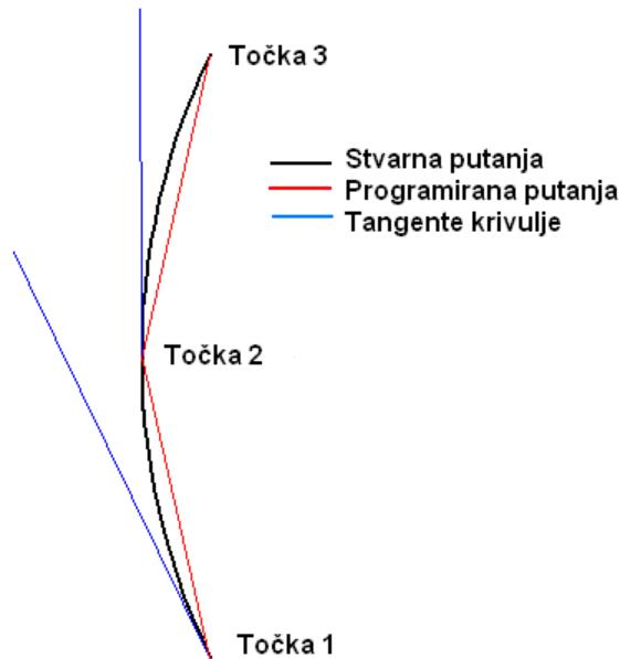
**Slika 4.22** Grafički prikaz putanje s naznačenom stvarnom i programiranoj putanjom te tangentama krivulje kod uzorka kutnog spoja
