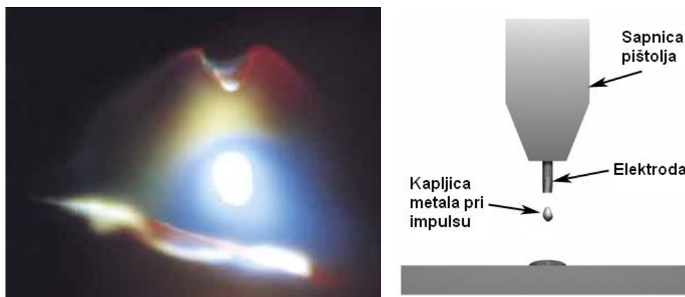
Slika 2.6 Prijenos metala impulsnim strujama: a) realni prikaz, b) shematski prikaz [3]
