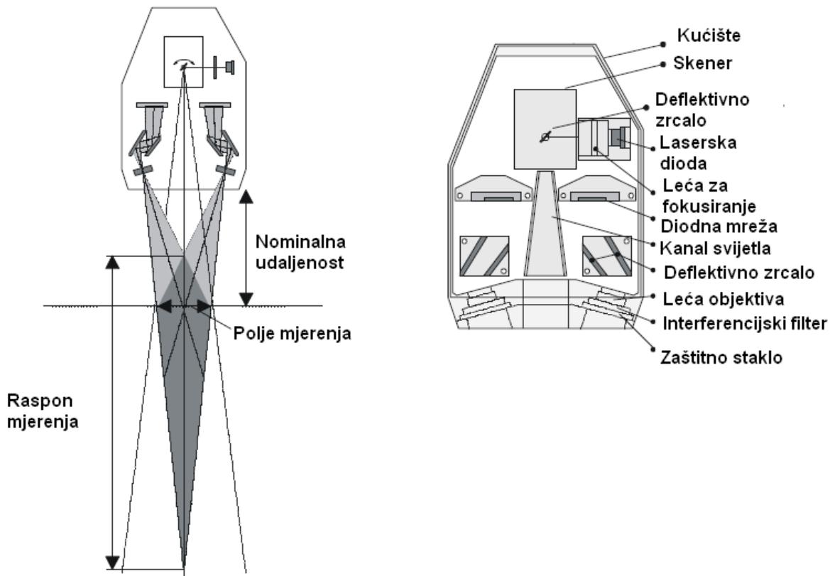
*Slika 3.30 Optički senzor za skeniranje žljeba kod multi-senzorskog robotskog sustava za MIG/MAG zavarivanje [17]*
