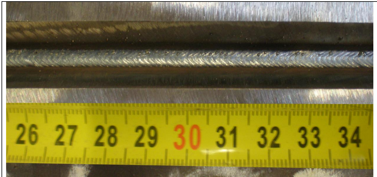
Parametri zavarivanja (prijenos metala kratkim spojevima)
