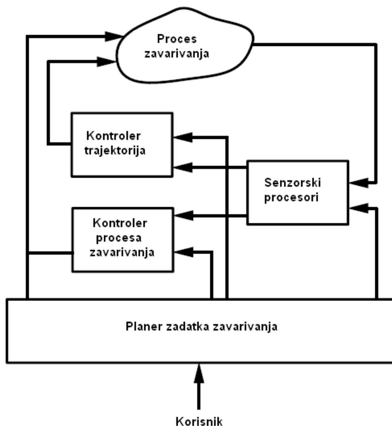
*Slika 3.28 Modularna arhitektura adaptivnog upravljanja robotiziranim procesom zavarivanja [16]*
