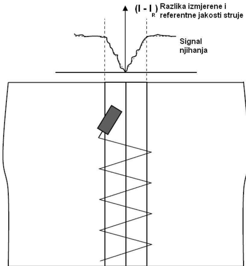
*Slika 3.23 Shematski prikaz procesa zavarivanja kod kojeg nema devijacije žljeba [12]*
