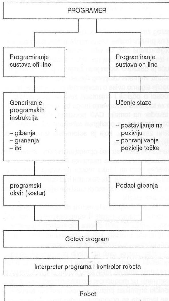
**Slika 3.15 Blok dijagram za mješovitu (hibridnu) metodu programiranja [6]**
