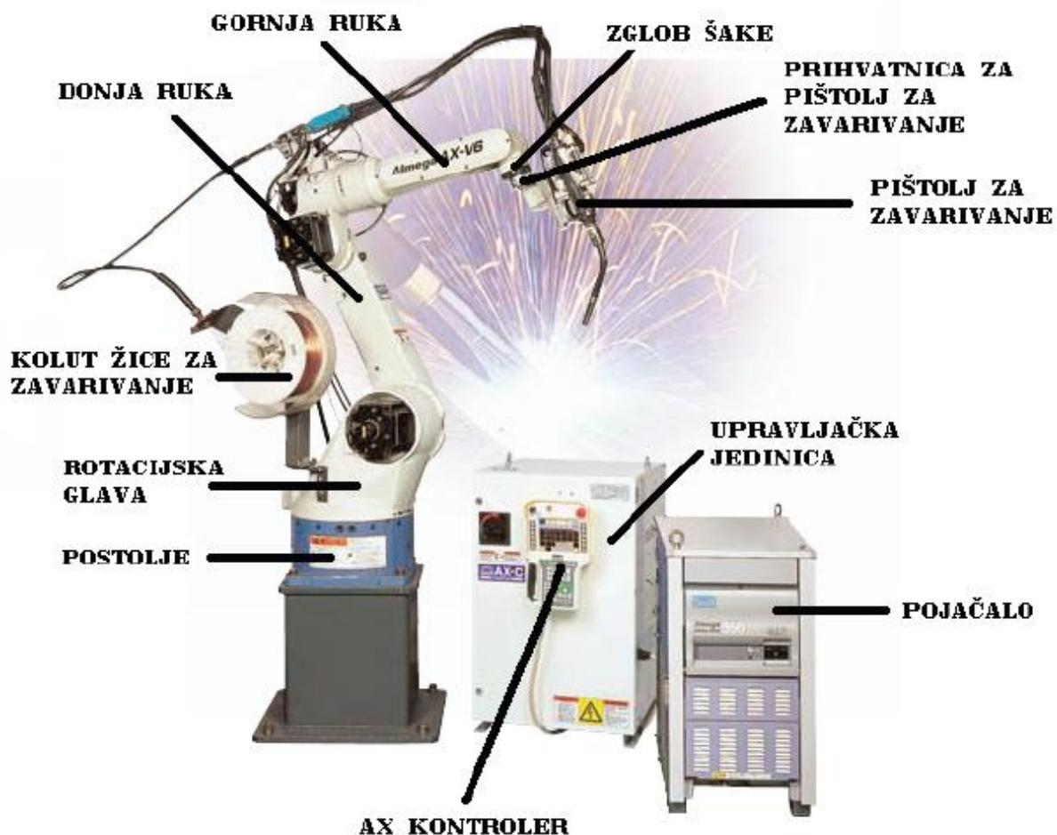
*Slika 4.3 Dijelovi robota OTC Almega AX, serije V6 [19]*
