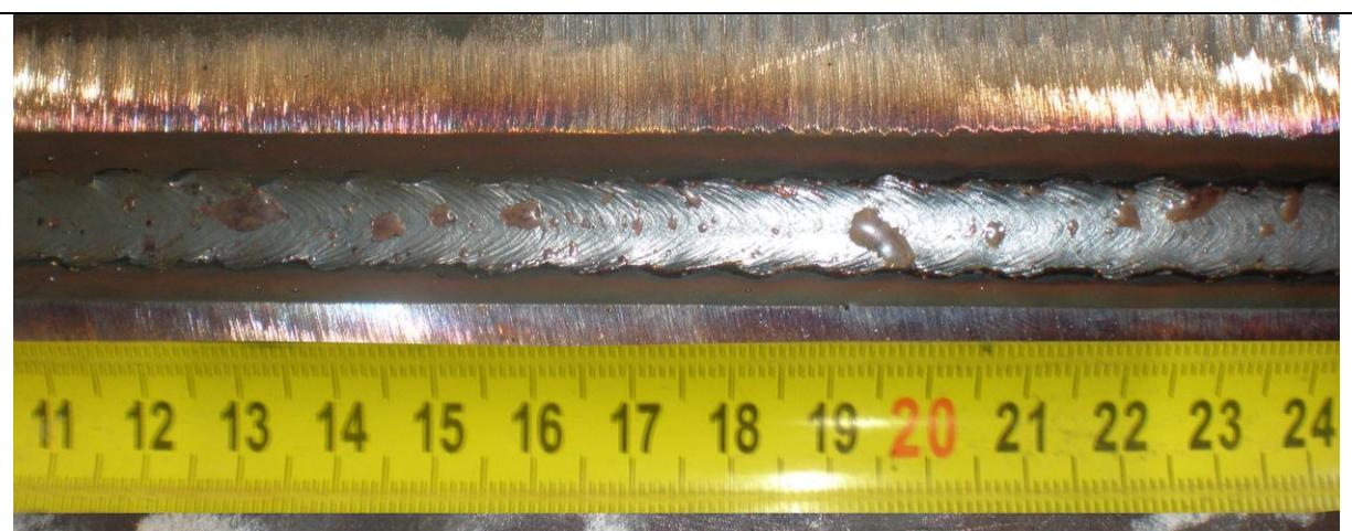
*Slika 4.33 Drugi prolaz uzorka I sučeljenog spoja i primjenjeni parametri*
