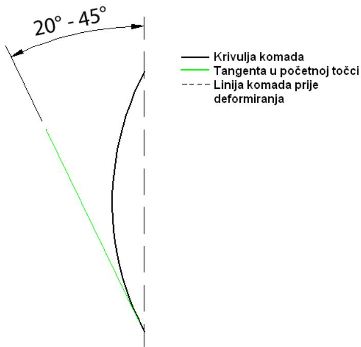
*Slika 4.21 Predviđeni kut deformiranja uzorka kutnog spoja*
