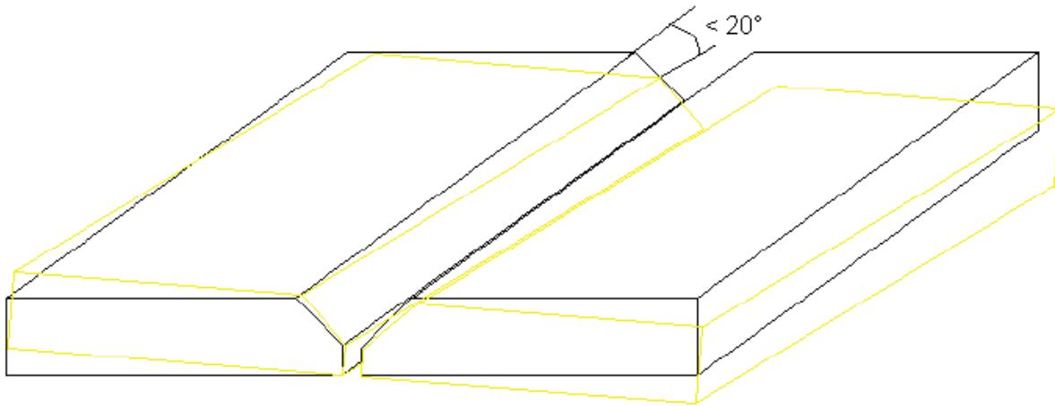
*Slika 4.11 Kut horizontalnog odmaka uzorka sučeljenog spoja*
