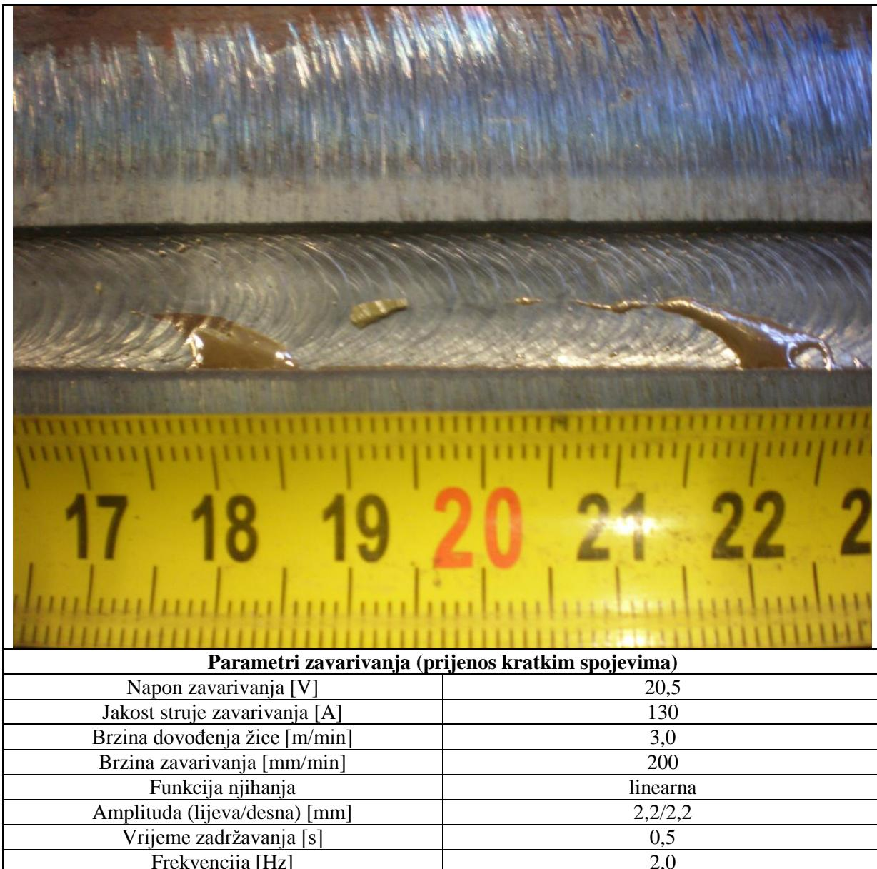
*Slika 4.39 Korijenski prolaz uzorka 2 sučeljenog spoja i primjenjeni parametri*
