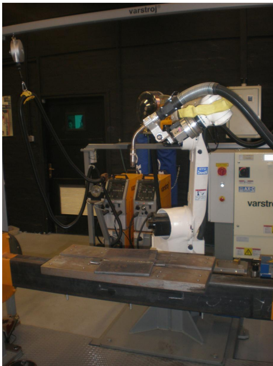
Slika 4.4 Robotska stanica s robotom OTC Almega AX-V6 u Laboratoriju za zavarene konstrukcije
