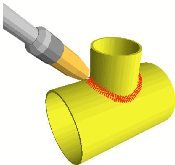
*Slika 3.27 Simulacijski prikaz praćenja kompleksnog T-spoja dviju cijevi električnim lukom kao senzorom (korekcije i položaja i orientacije – 6D praćenje) [15]*
