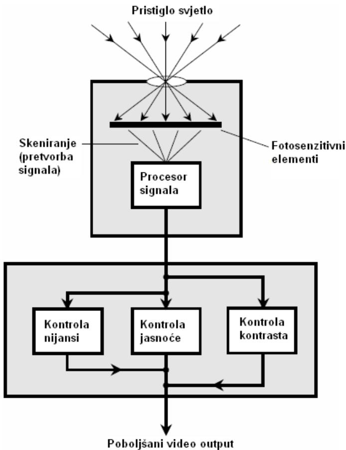
*Slika 3.18 Pojednostavljeni blok dijagram CCD kamere [13]*
