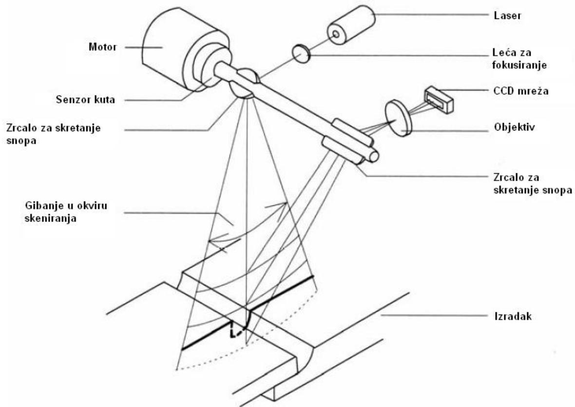
Slika 3.19 Shematski prikaz triangulacijskog skeniranja geometrije spoja [12]
