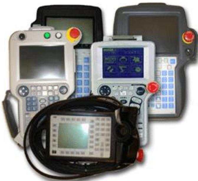
*Slika 3.10 Upravljačke ploče različitih industrijskih robota [7]*
