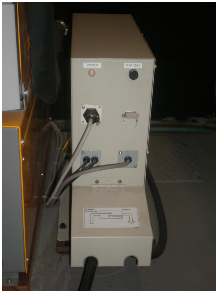
Slika 4.8 Senzor AX-AR u okviru robotske stanice s robotom OTC Almega AX-V6 u Laboratoriju za zavarene konstrukcije
