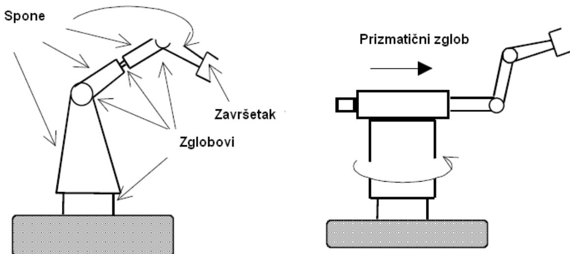
*Slika 3.1 Shematski prikaz spona i zglobova robotskog manipulatora [4]*
