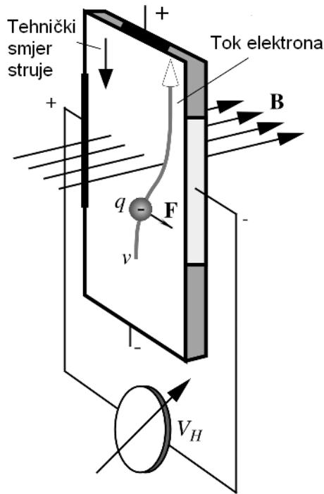
*Slika 3.16 Princip Hallovog efekta (q-naboj, v-brzina gibanja naboja, F-sila djelovanja magnetskog polja, B-magnetska indukcija,  $V_H$  -Halova, transverzalna razlika potencijala)[11]*
