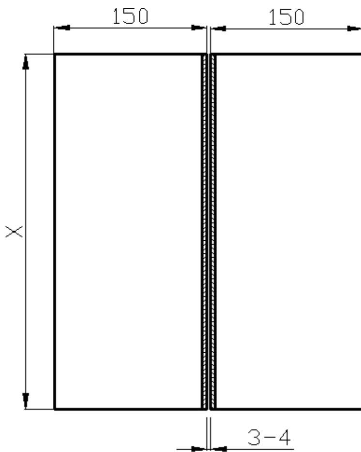
**Slika 4.10** Dimenzije uzorka sučeljenog spoja:  $x_1=350\text{mm}$  (uzorak 1),  $x_2=250\text{mm}$  (uzorak 2),  $x_3=255\text{mm}$  (uzorak 3)
