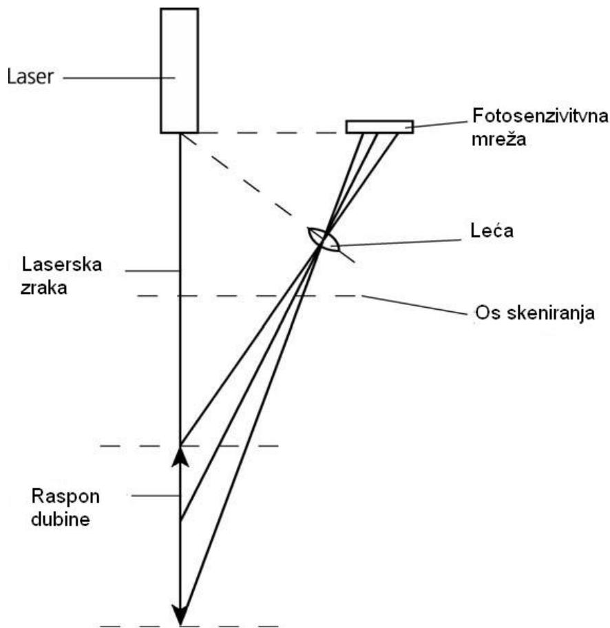
*Slika 3.17 Princip djelovanja optičkog, laserskog senzora za praćenje žlijeba[12]*
