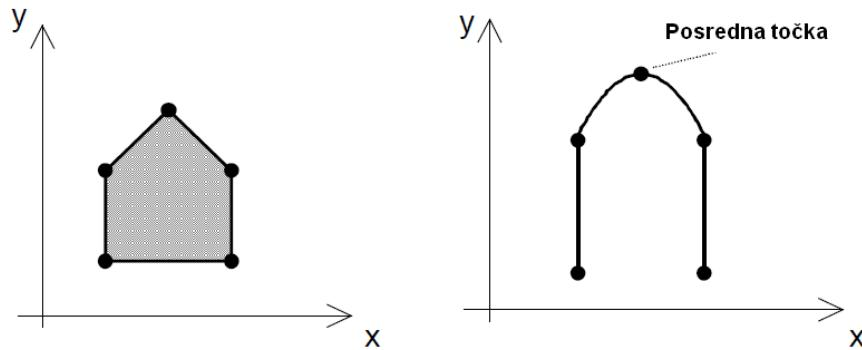
*Slika 3.6 Grafički prikaz gibanja robota po kontinuiranoj putanji s linearom interpolacijom (lijevo, definirana početnom i završnom točkom) i kružnom interpolacijom (desno, definirana s početnom, posrednom i završnom točkom) [4]*
