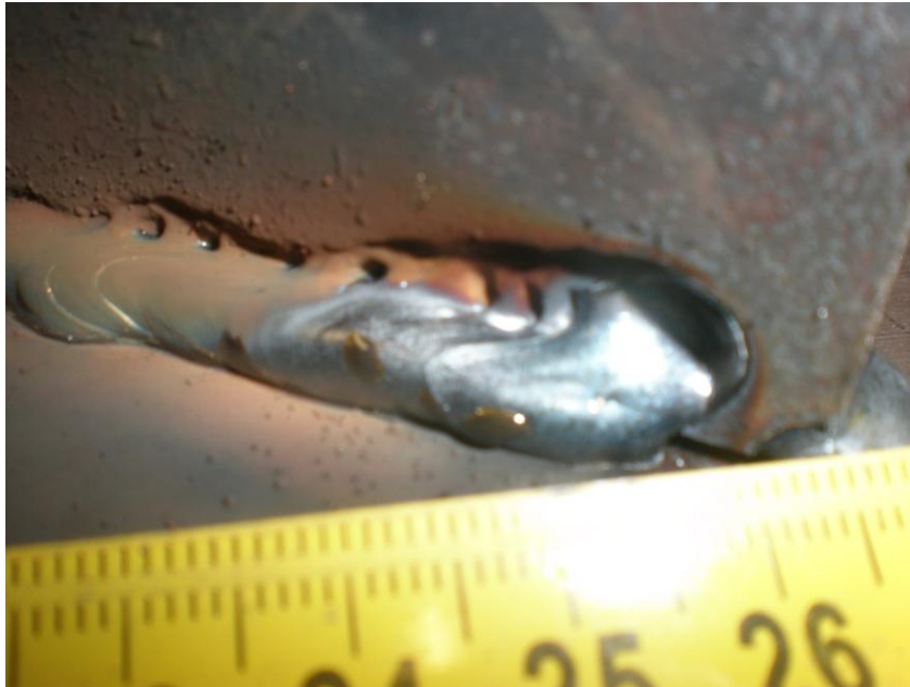
Slika 4.59 Skretanje zavara prema vertikalnoj ploči na kraju uzorka 2 kutnog spoja uslijed utjecaja zazora
