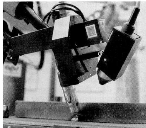
*Slika 3.33 Realni prikaz senzorskog sustava za praćenje spoja te područja slobodnog kraja žice, električnog luka i taline [17]*
