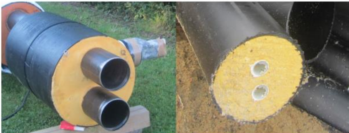
Slika 11 Primjer fleksibilnih i čeličnih cijevi [15]
