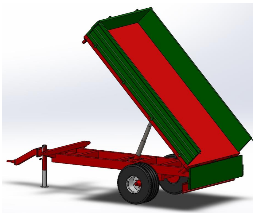
Slika 43. 3D prikaz prikolice s nagibom sanduka od 45° unazad sa stražnje strane
