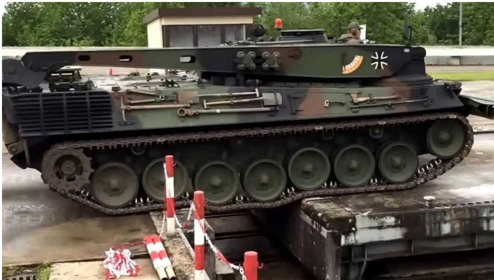
Slika 16. Prelazak vozila na gusjenicama preko rova [21]
