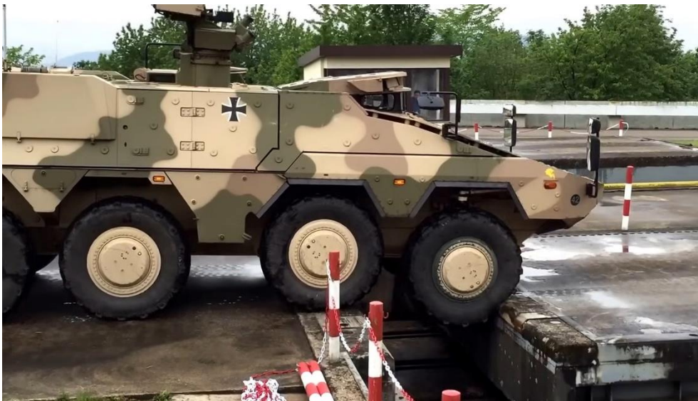
Slika 18. Prelazak vozila na kotačima preko rova [21]
