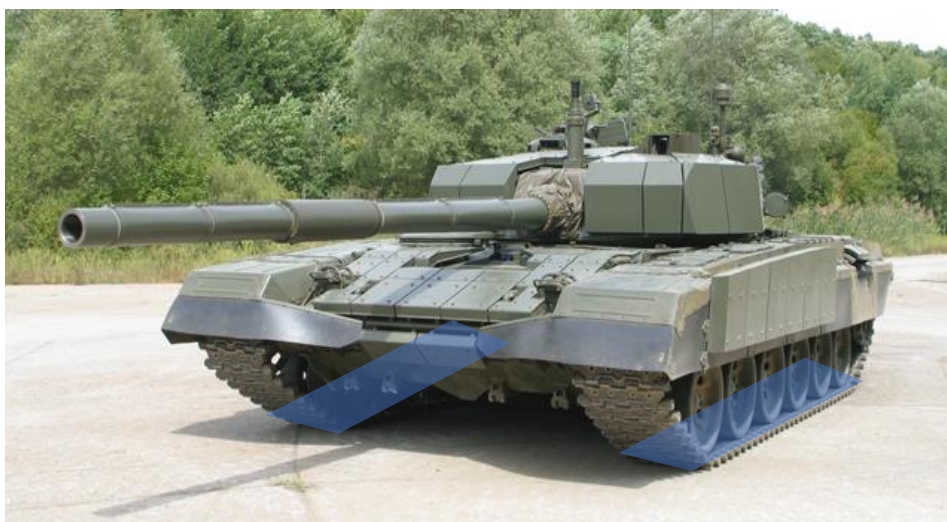
Slika 15. Dodirna površina gusjenica tenka M-84 i podloge [18]
