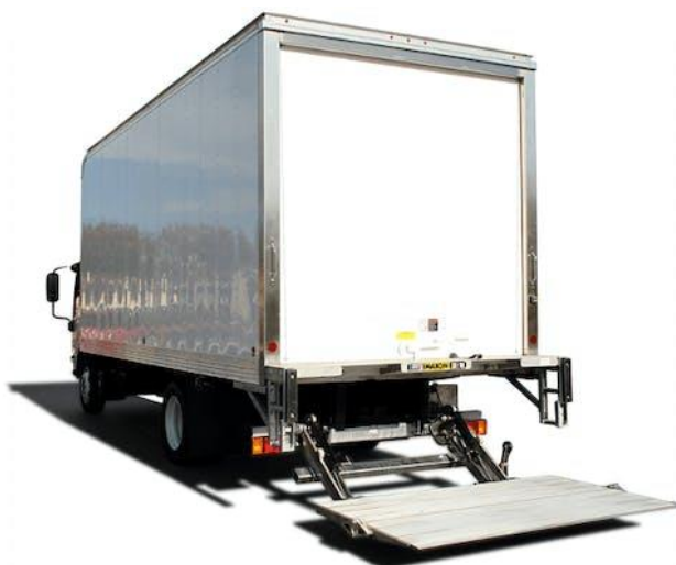
Slika 1. Transportno vozilo sa naknadno ugrađenom utovarnom rampom
