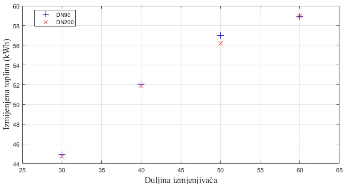
**Slika 21** Ovisnost izmijenjene topline o duljini izmjenjivača
