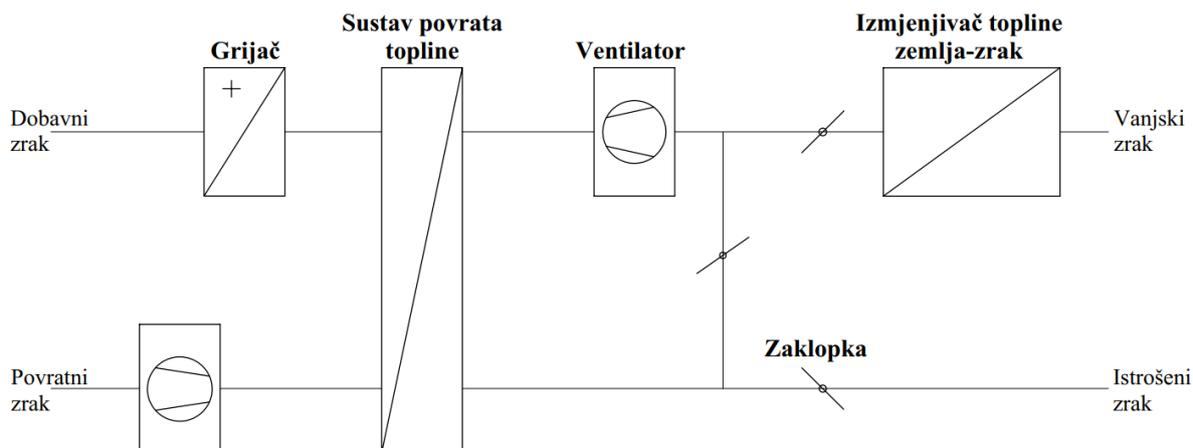
**Slika 1** Pojednostavljena shema sustava za grijanje i ventilaciju sa izmjenjivačem topline zemlja-zrak za predpripremu zraka
