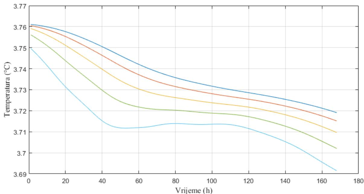
**Slika 25 Vremenska promjena srednje temperature pet slojeva tla najbližih cijevi izmjenjivača**
