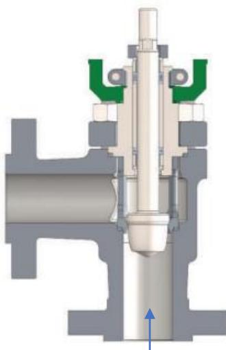
**Slika 1 Regulacijski kutni ventil, strujanje medija otvara ventil [2]**
