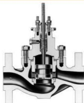
**Slika 5 Spoj poklopca ventila i kućišta [2]**
