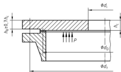
Slika 16 Brtva unutar promjera na kojem su vijci [8]
