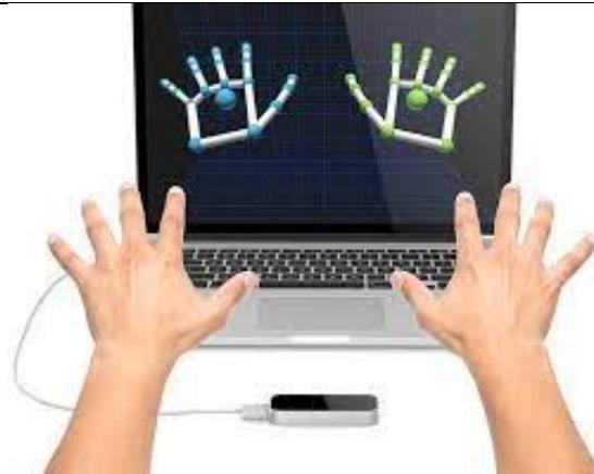
Slika 19. Leap motion kontroler [17]
