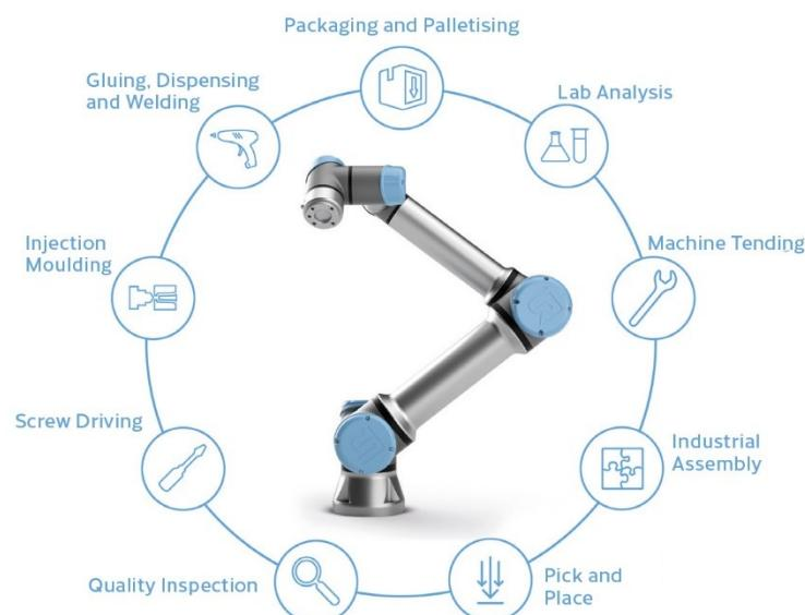
Slika 11. Primjena kolaborativnih roboata [10]
