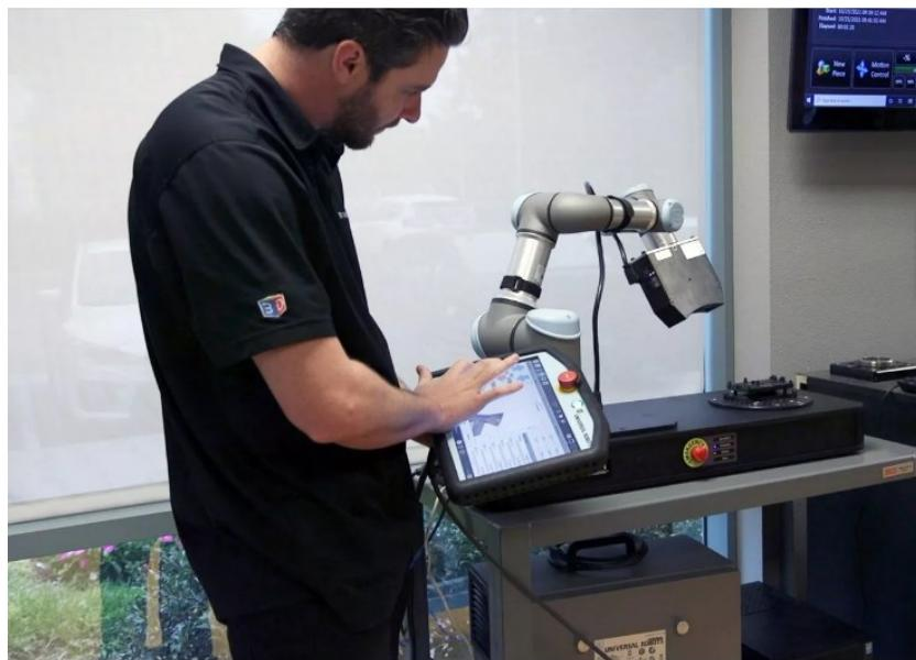
Slika 20. Upravljanje robotom pomoću kontrolnog uređaja [18]
