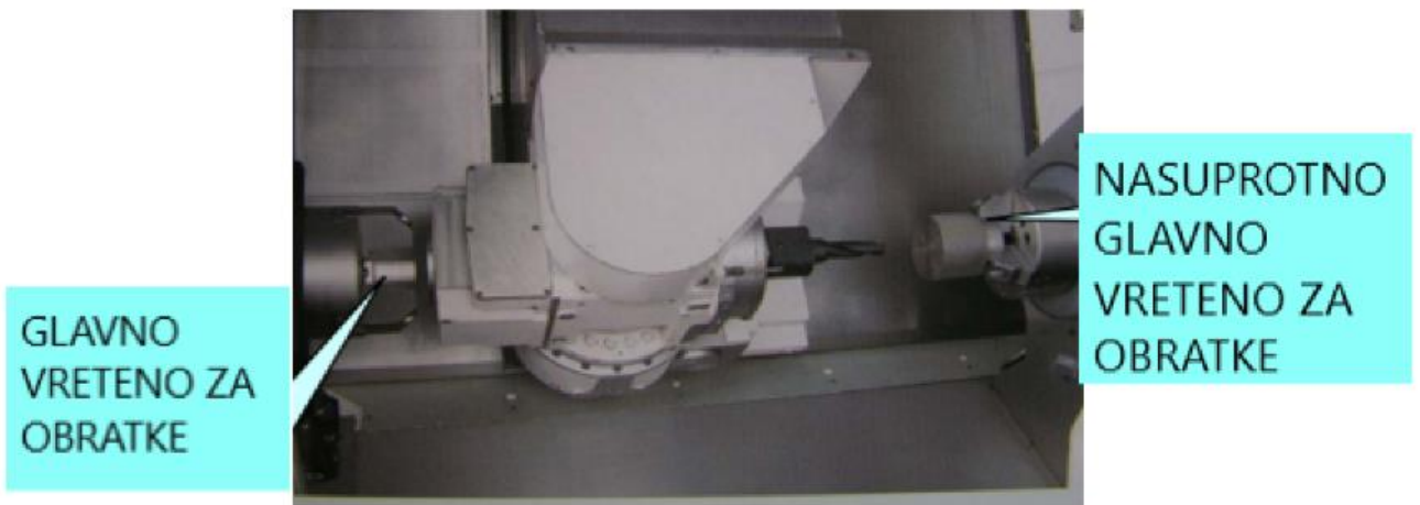
Slika 8. W izvedba višenamjenskih obradnih strojeva [4]
