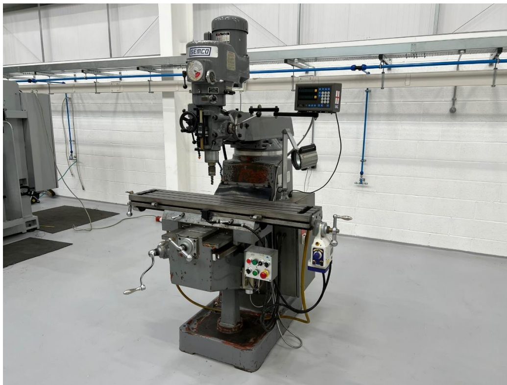
Slika 3. Semco LC-185VS numerički upravljana glodalica [7]
