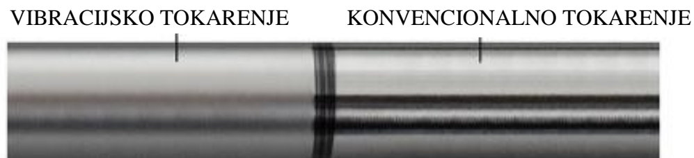
Slika 25. Obradak kod kojeg je s lijeve strane korišteno vibracijsko tokarenje, a desno konvencionalno tokarenje u istim uvjetima [22]
