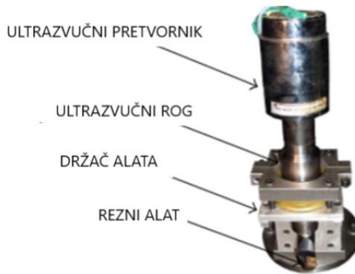
Slika 24. Struktura alata i vibracijskog sustava [22]
