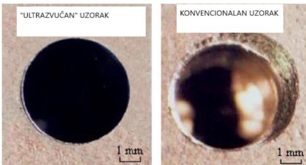
Slika 22. Usporedba izbušenih rupa: lijevo-strojna obrada potpomognuta vibracijama, desno-konvencionalna strojna obrada [21]
