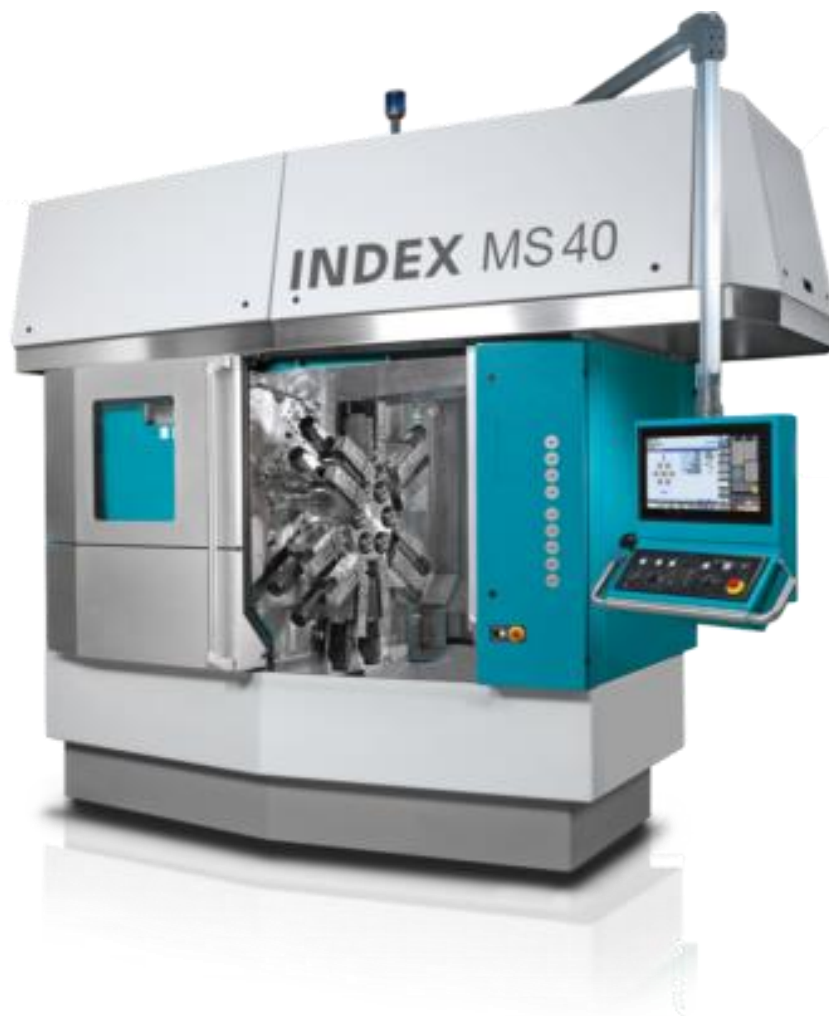
Slika 19. Stroj INDEX MS 40-6 koji ima 6 glavnih vretena [17]
