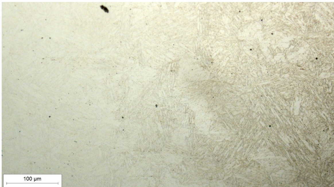
Slika 35. Mikrostruktura ZUT-a u sredini zavora snimljena pri povećanju 200×
