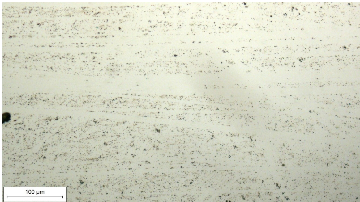
Slika 30. Mikrostruktura osnovnog materijala snimljena pri povećanju 200×
