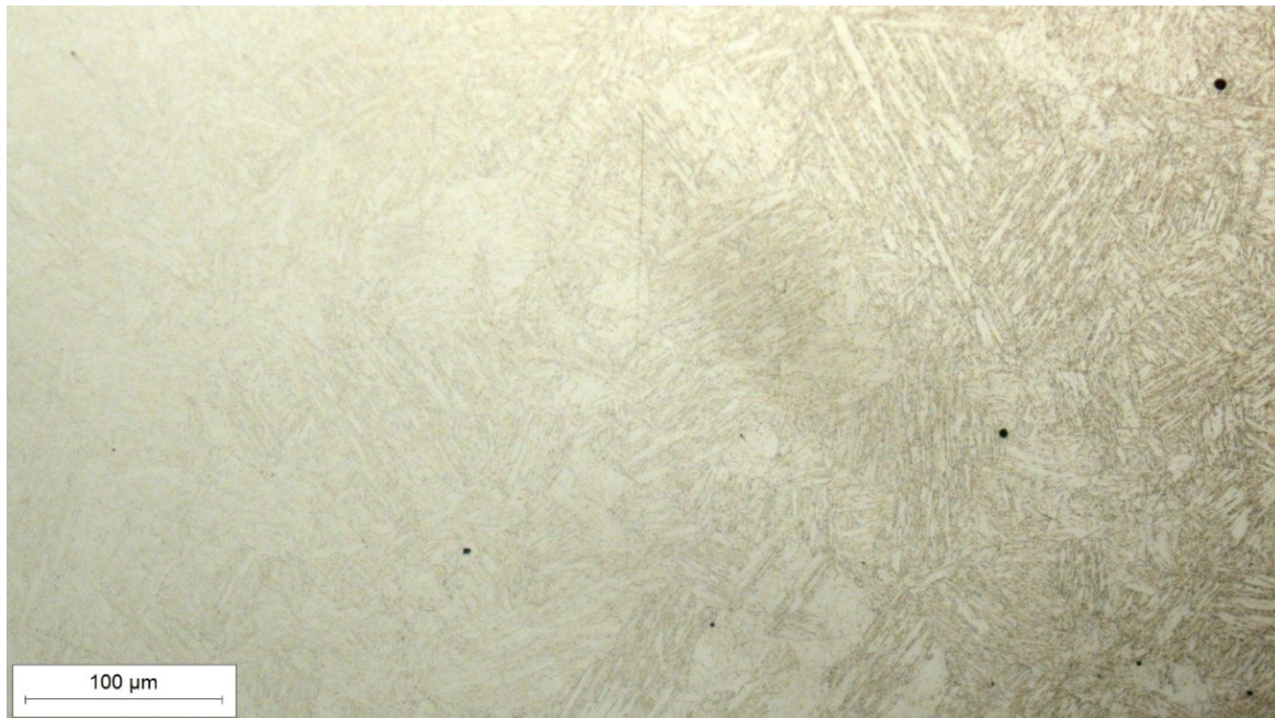
Slika 34. Mikrostruktura ZUT-a korijena zavora snimljena pri povećanju 200×
