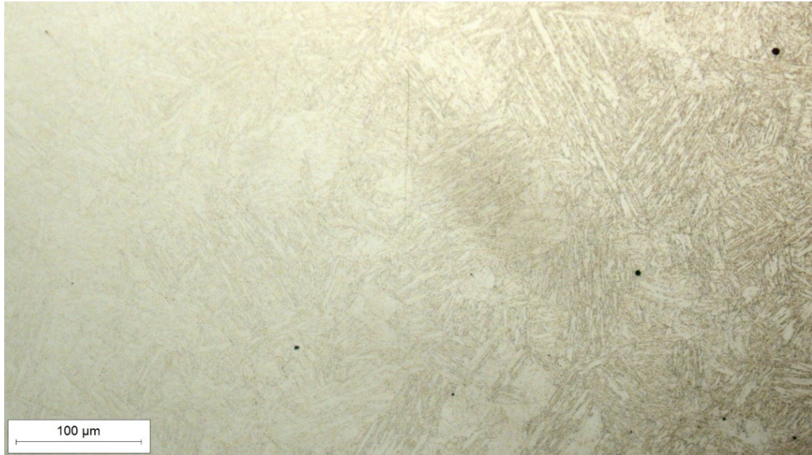
Slika 34. Mikrostruktura ZUT-a korijena zavora snimljena pri povećanju 200×
