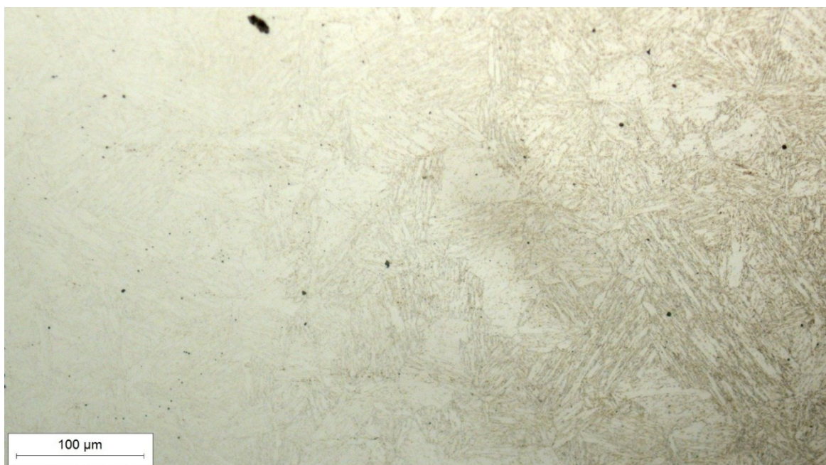
Slika 35. Mikrostruktura ZUT-a u sredini zavora snimljena pri povećanju 200×
