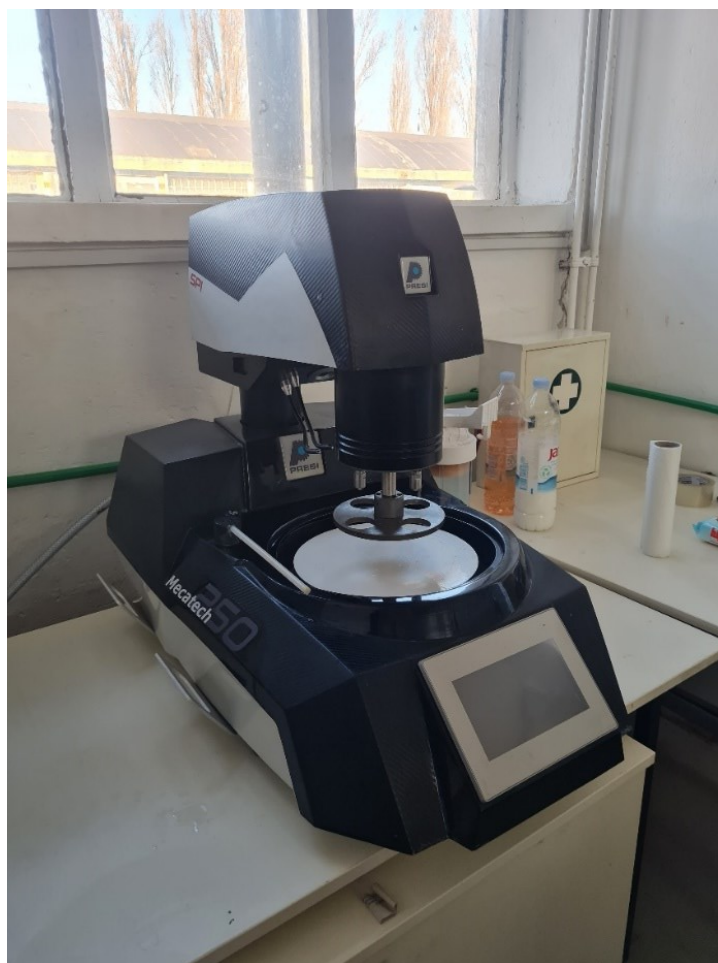
Slika 23. Uređaj za brušenje i poliranje
