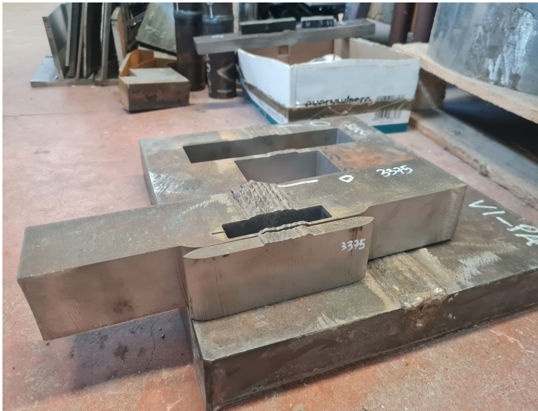
Slika 17. Izrezani komadi martenzitnog nehrđajućeg čelika
