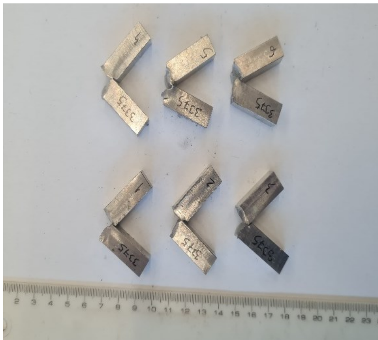
Slika 40. Uzorci na kojima je mjerena žilavost
