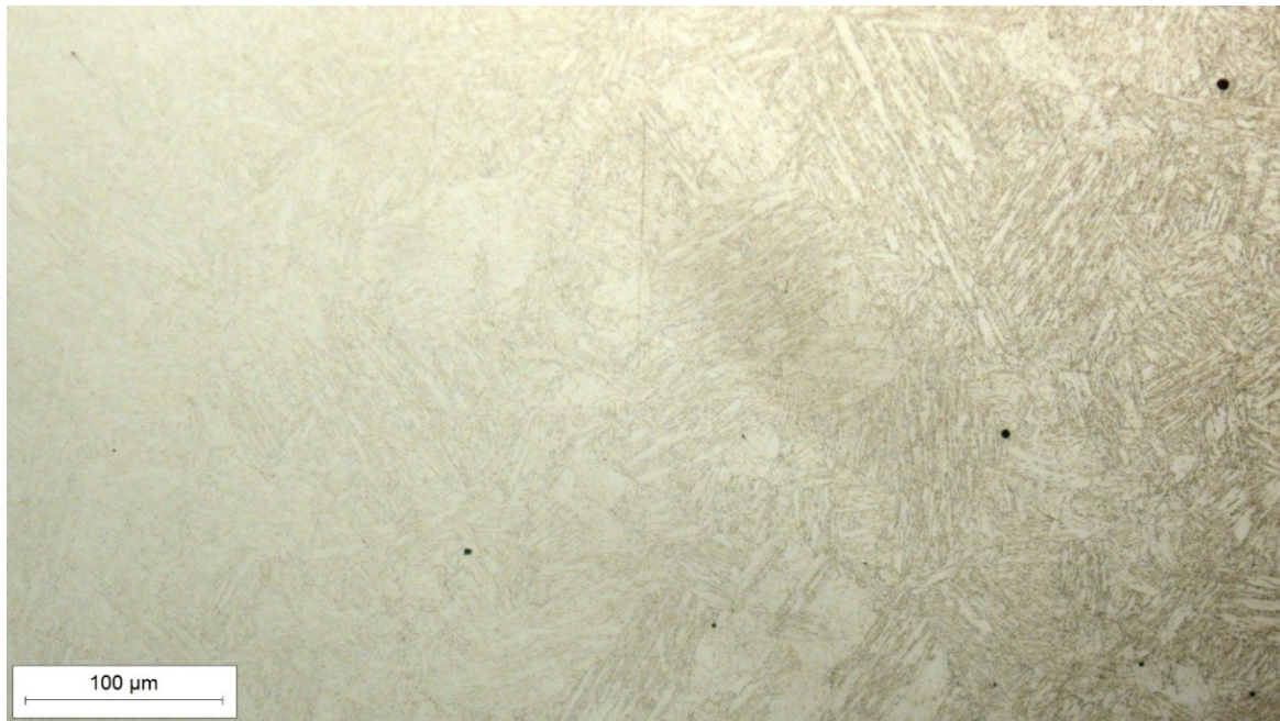
Slika 34. Mikrostruktura ZUT-a korijena zavora snimljena pri povećanju 200×
