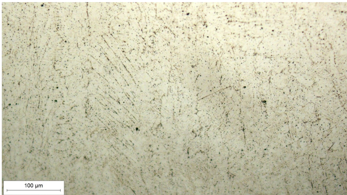
Slika 31. Mikrostruktura metala zavara snimljena pri povećanju 200×
