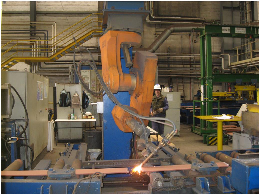
Slika 3.2 - Prikaz robotske ruke prilikom rezanja
