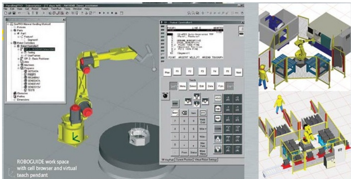
Slika 5.3 - Prikaz sučelja programskog paketa ROBOGUIDE
