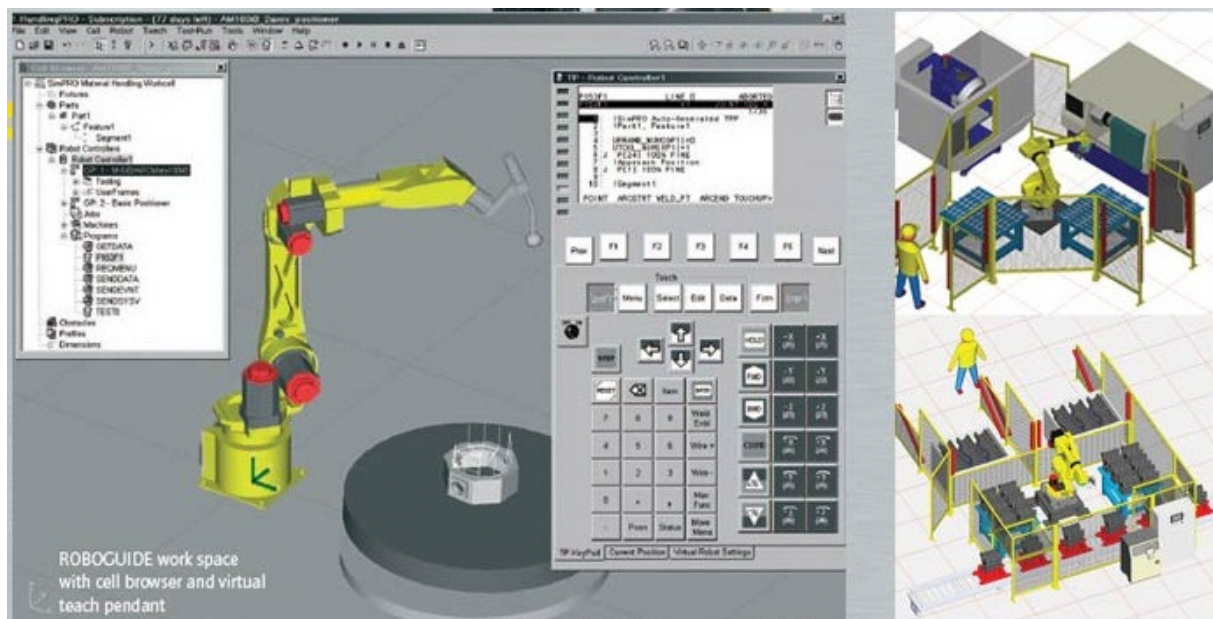
Slika 5.3 - Prikaz sučelja programskog paketa ROBOGUIDE
