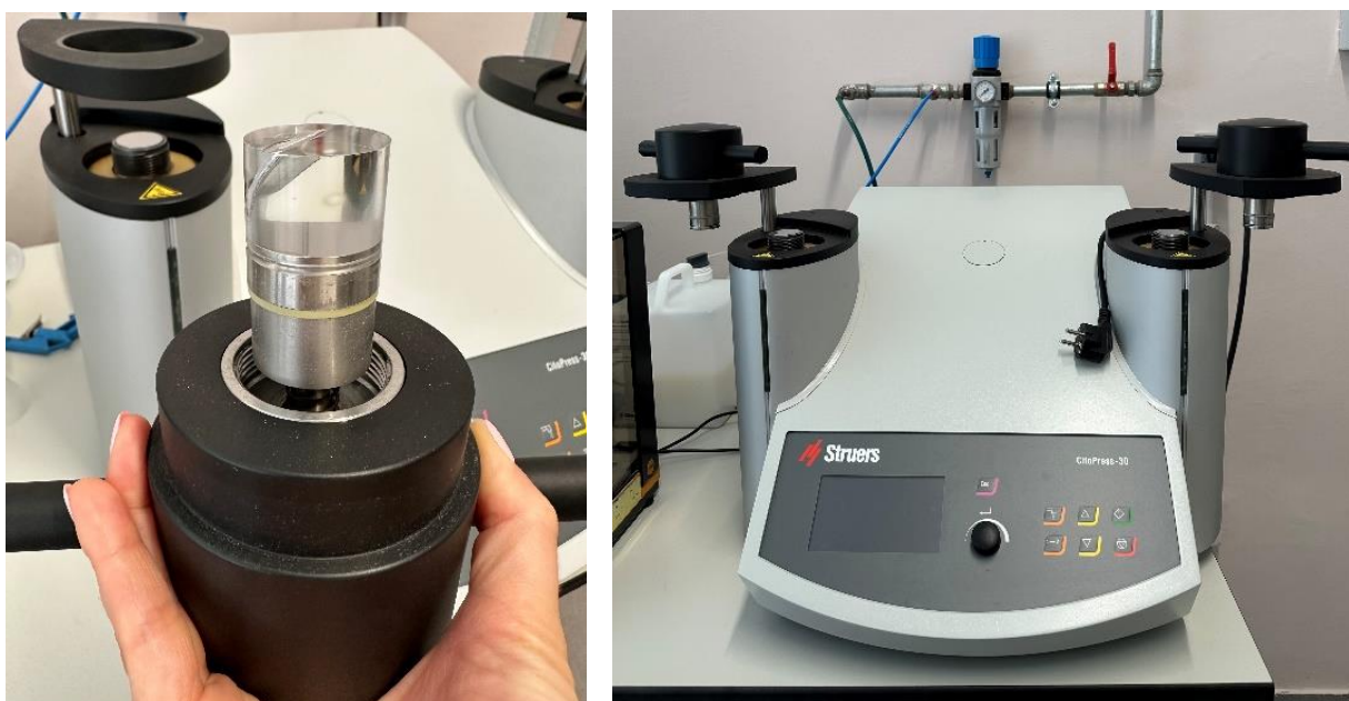
Slika 13. Vruće zalijevanje ispitnog uzorka: a) izgled uzorka, b) uređaj Struers CITOPRESS 30
