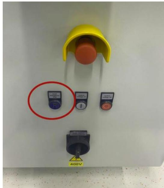
Slika 18. Uključivanje glavnog PLC-a.
