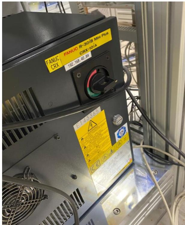
Slika 21. Sklopka za uključivanje robota FANUC CRX-10iA
