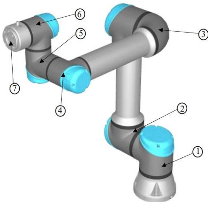
Slika 7. Zglobovi robota [4]
