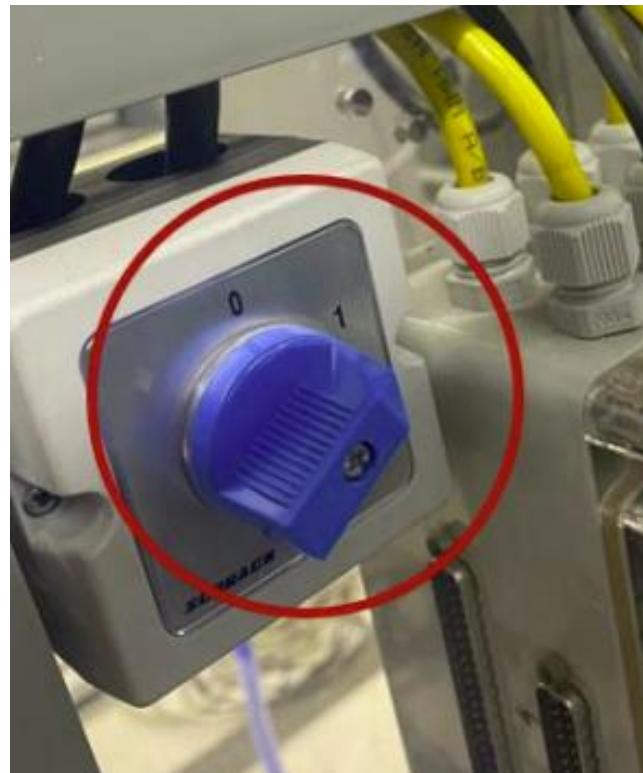
Slika 20. Sklopka PLC-a.
