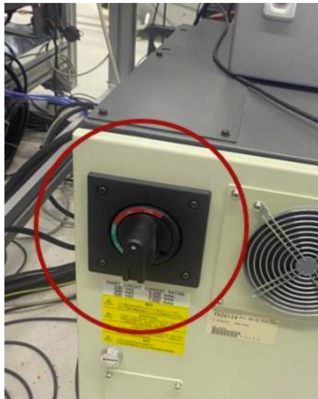
Slika 23. Sklopa za uključivanje robota FANUC CR-15iA
