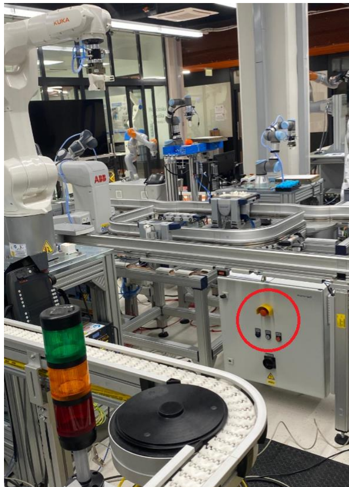
Slika 17. Lokacija upravljačke jedinice.
