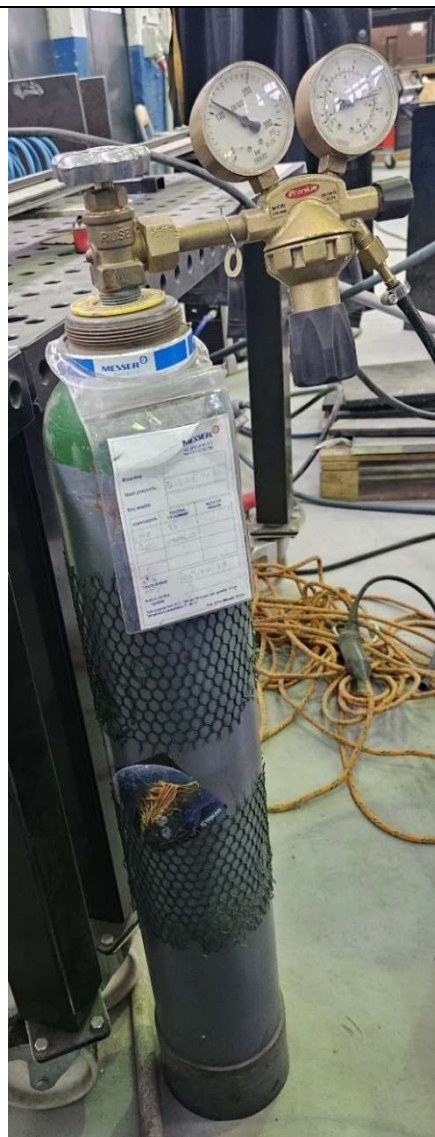
Slika 18. Zaštitna plinska mješavina argona i helija u omjeru 85:15
