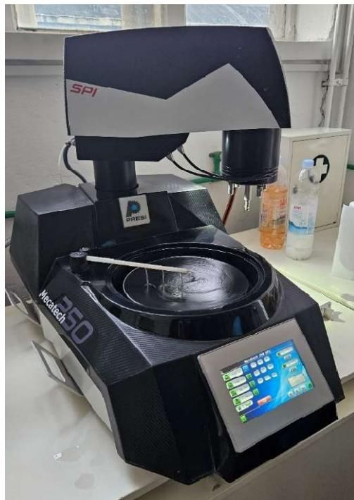
Slika 24. Stroj za poliranje Mecatech 250
