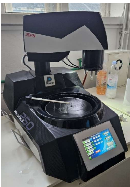
Slika 24. Stroj za poliranje Mecatech 250
